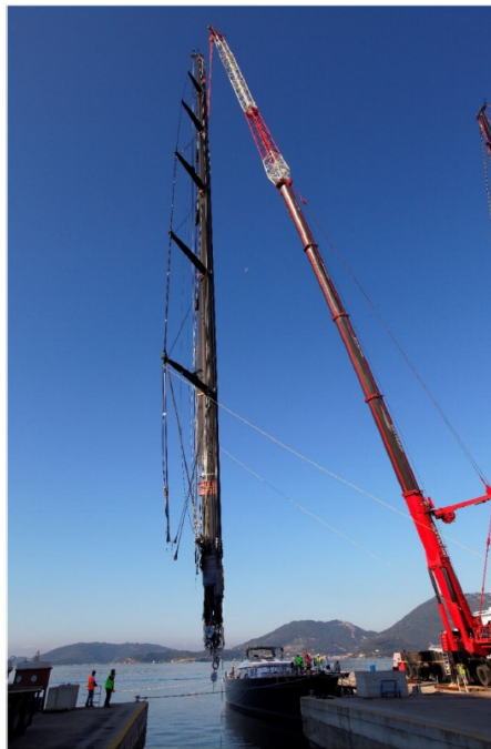
Figure 1-42 : Procédure de pesage d'un mât en fibre de carbone [240]
