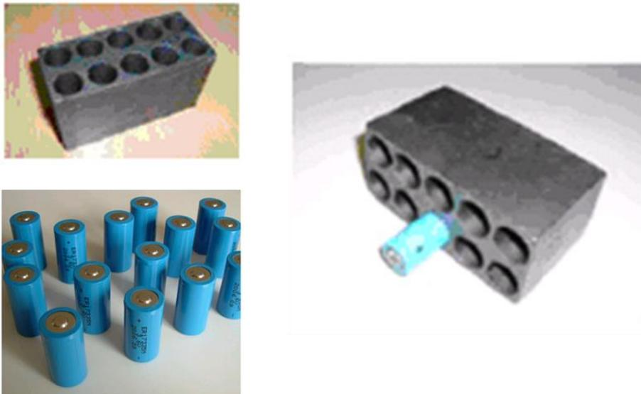
Figure 2.13 : Assemblage des cellules de batterie dans une matrice MCP
