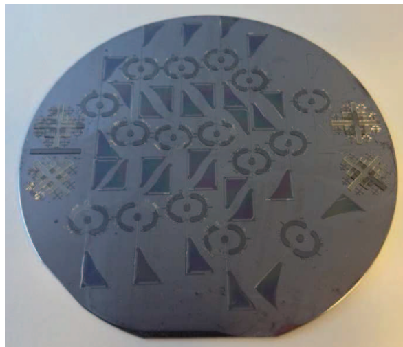
Figure 5.10 : 16 thorax développés en SU-8 sur un substrat de silicium de 3 pouces, dont un sans membrane
