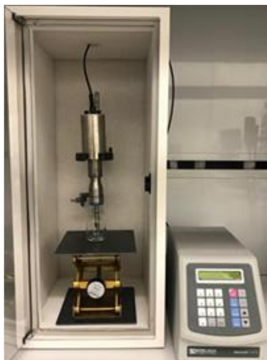
Figure II.2: montage de l'appareil de sonication à sonde de titane métallique (Vibracell 75115 BIOBLOCK SC puissance 500W).
