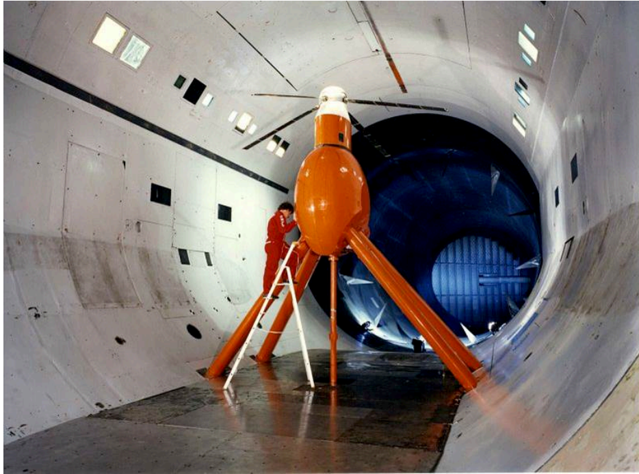
FIGURE 2.5 – Rotor 7A monté dans la soufflerie S1MA, ONERA, Modane.
