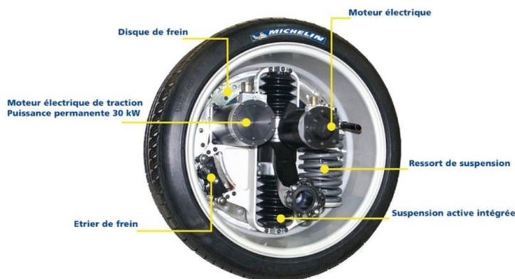
FIGURE 1.29 – Structure de l'Active Wheel
