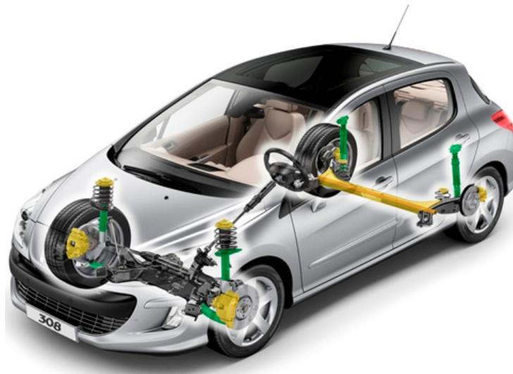
FIGURE 1.9 – Vue par transparence des éléments constitutifs d'une LAS
