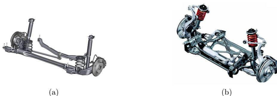
FIGURE 1.23 – Architectures de suspension des trains arrière : l’essieu de torsion (a) est très répandue simple et robuste [Carbibles, 2009] tandis que le multibras (b) est d’une conception plus complexe mais très efficace notamment en guidage [BMW, 2010].
