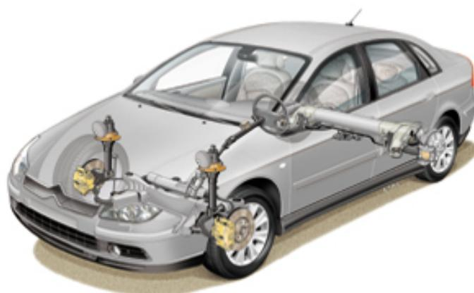
FIGURE 1.27 – Système de suspension Hydractive développé par Citroën
