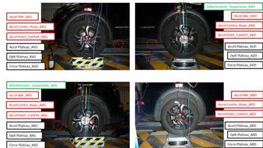
(d) Instrumentation de la DS7 CrossBack sur le B4V
