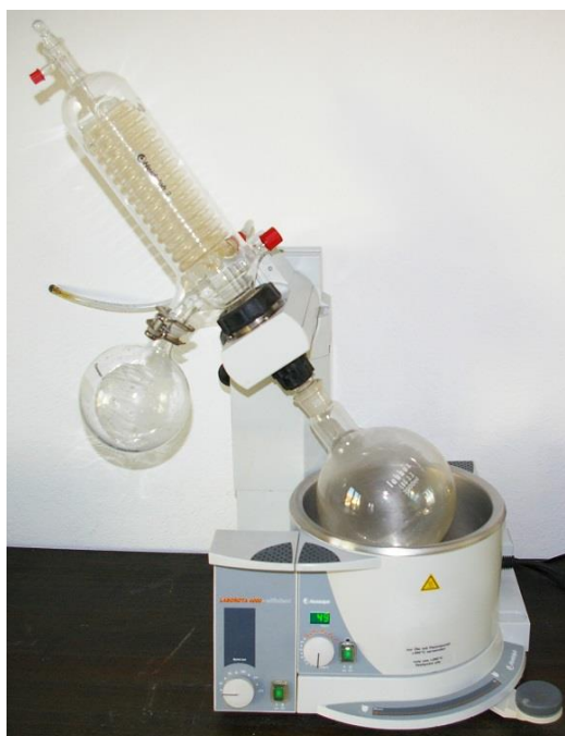
Fig.II.15 : Evaporateur rotatif LABOROTA 4000
