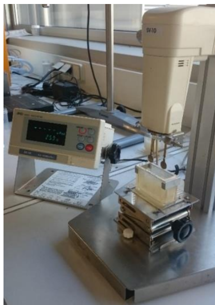
Fig.II.7 : Viscosimètre à vibration
