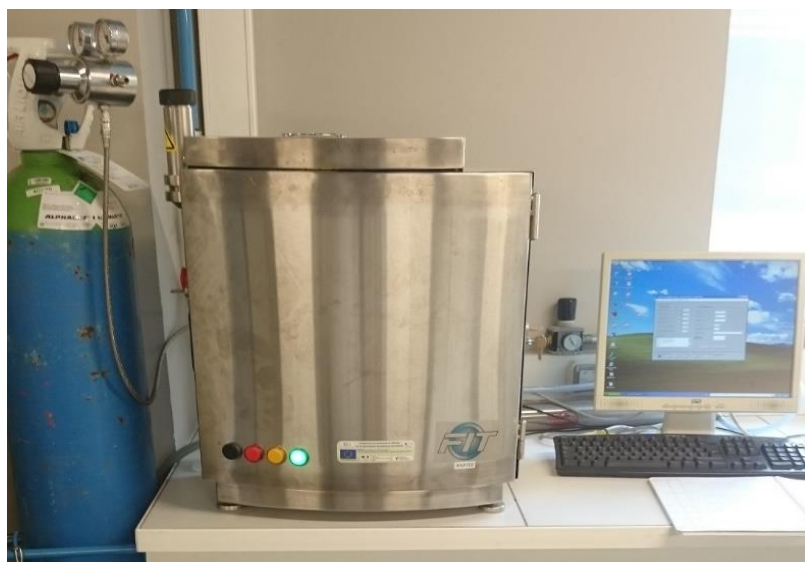
Fig.II.13 : Appareil de mesure d'indice de cétane (Fuel Ignition Tester - FIT)
