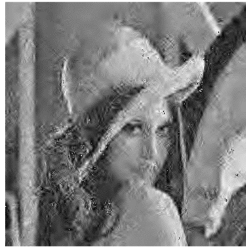
Une erreur produite au milieu du flux SPIHT compressé
