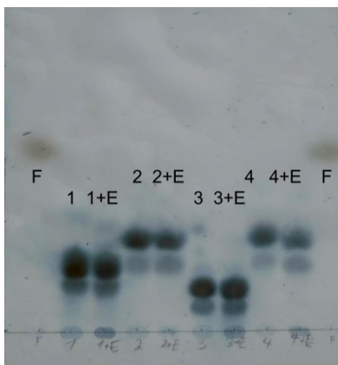
Figure 48 : TLC réalisée après incubation de la GH29 avec quatre oligosaccharides fucosylés. F : fucose, 1 : \alpha 1-3Galactosyl-3Fucosyllactose, 2: 2'Fucosyllactose, 3 : Lacto-N-fucopentaose I, 4 : 3-Fucosyllactose, +E : substrat avec enzyme
