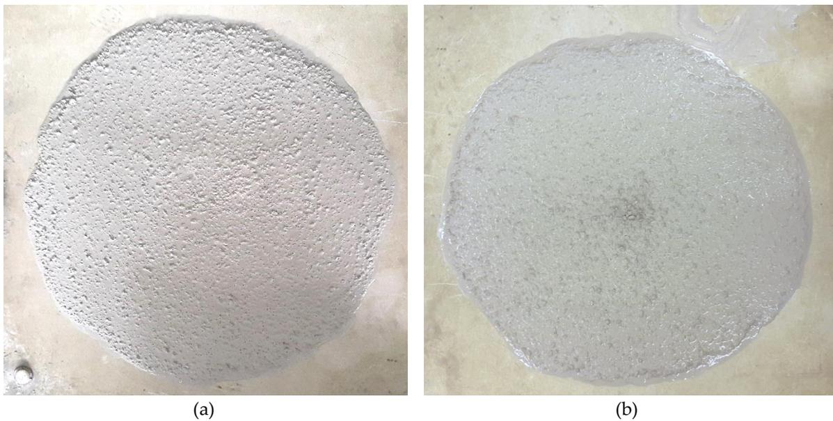
Figure 4.11 Spread flow C-0 at: a) 8 min, b) 90 min.
