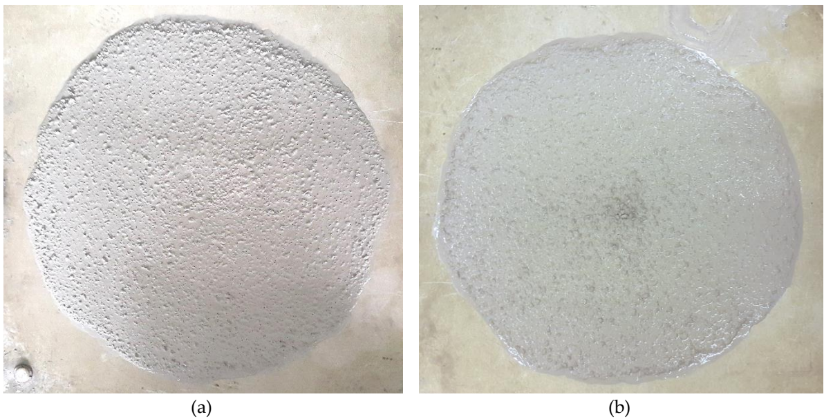
Figure 4.11 Spread flow C-0 at: a) 8 min, b) 90 min.
