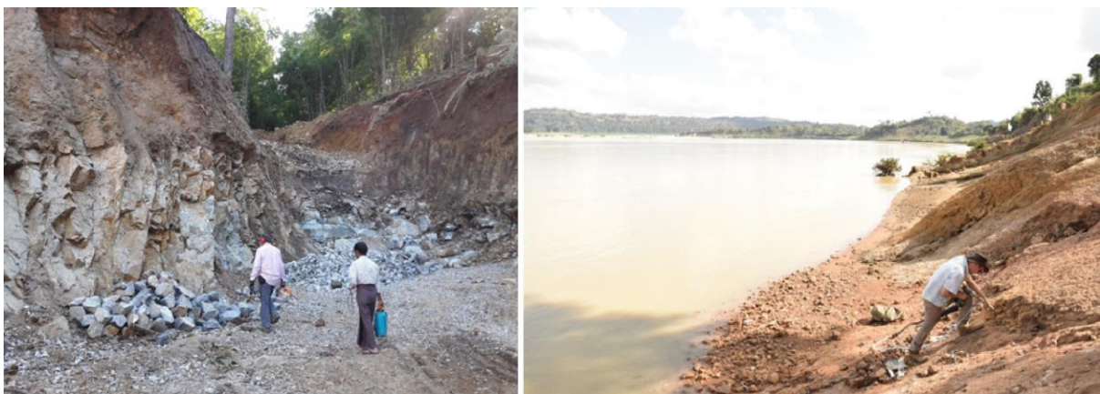
Figure 4 : Echantillonnage paléomagnétique des roches volcaniques (à gauche) et des sédiments (à droite) du Terrane de Birmanie. Plus de détails : Chapitre 3.
