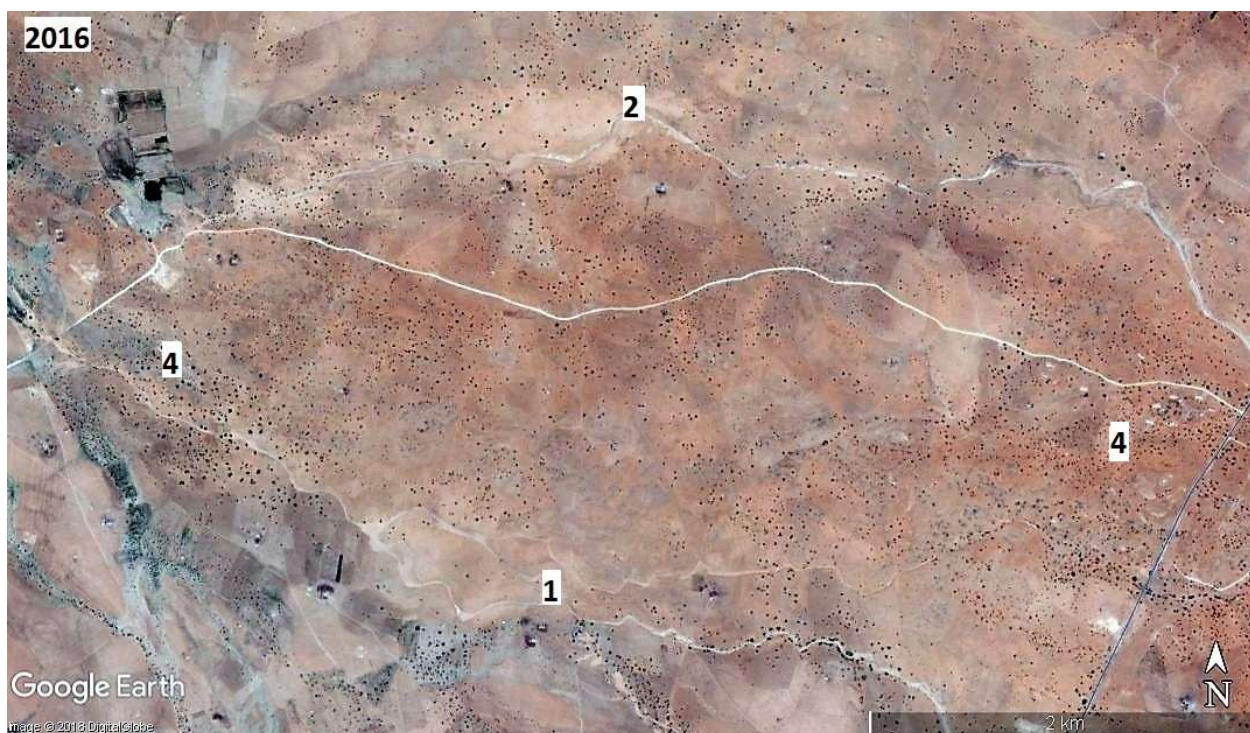
Figure 166 : Disparition du produit sableux mobile, reboisement contre l'ensablement (4) (Image GeoEye juillet 2016, 35°24'60"N - 3°21'31"E)
