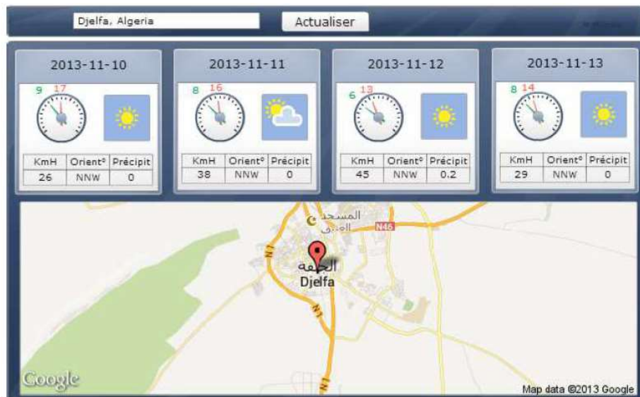
Figure 173 : Application de restitution de flux de données récupérées sur les prévisions météorologiques (Températures en min et max, vents : direction et vitesse, et précipitations)
