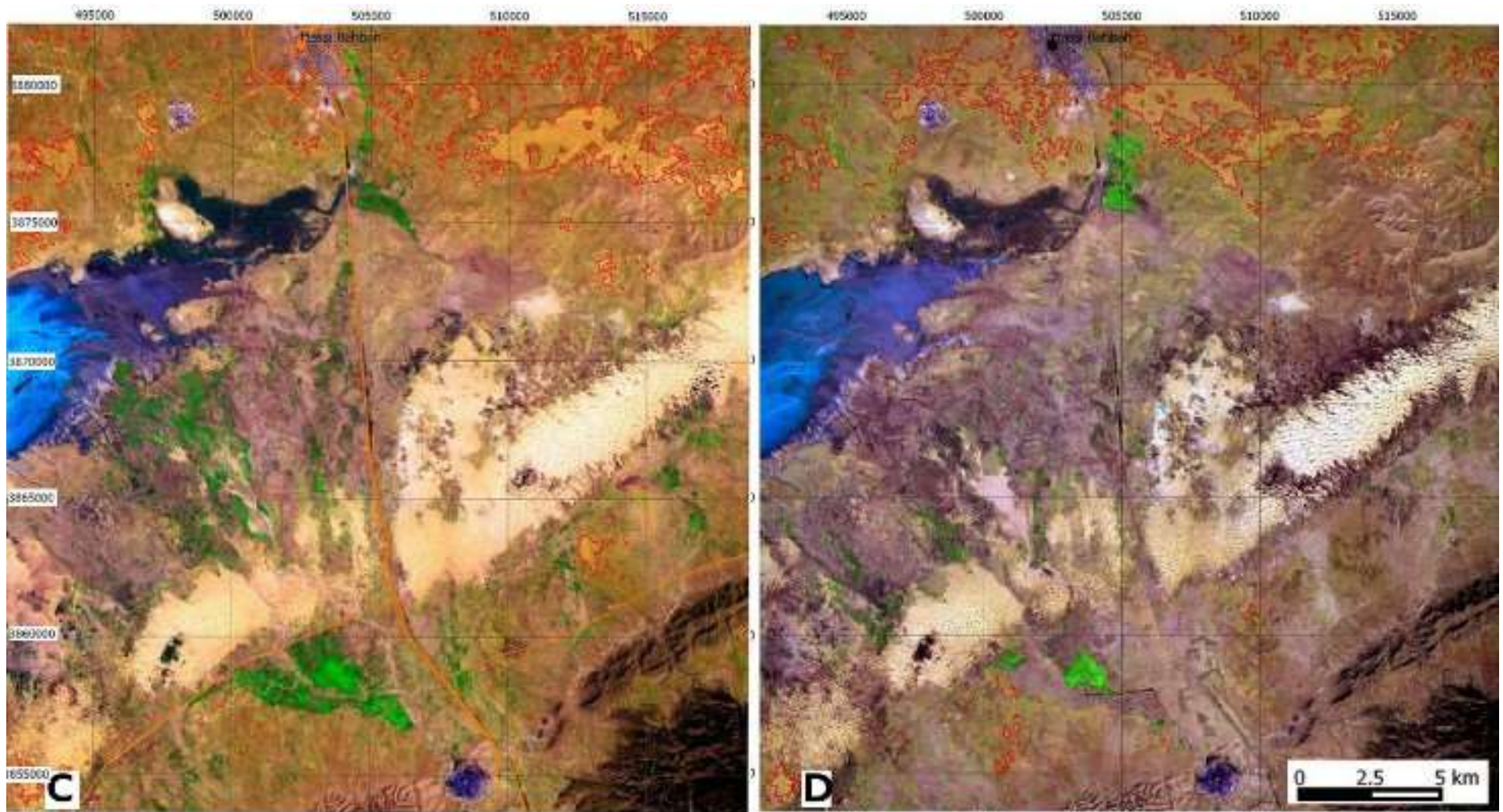
Figure 157 : Etat de la surface d'ensablement (sable vif et voiles sableux délimités par les contours rouges) sur l'image en composition colorée 5-4-1, site du Zahrez Gharbi. Images Landsat (C : 1995, SE = 32 km 2 ; D : 2001, surface ensablée = 38 km 2 )
