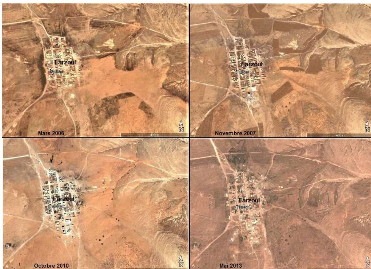
Figure 159 : Suivi temporel d'ensablement par des images à haute résolution, village de Farzoule. En 2006 le sable se concentre sur le côté Est ; En 2007, le labour reprend sur une partie de la zone ensablée, signe que la couche de sable est fine. En 2010, la couche sableuse entoure le village, mais a disparu complètement en 2013 (35° 4'31.56"N - 3°12'18.72"E ; Google Earth).
