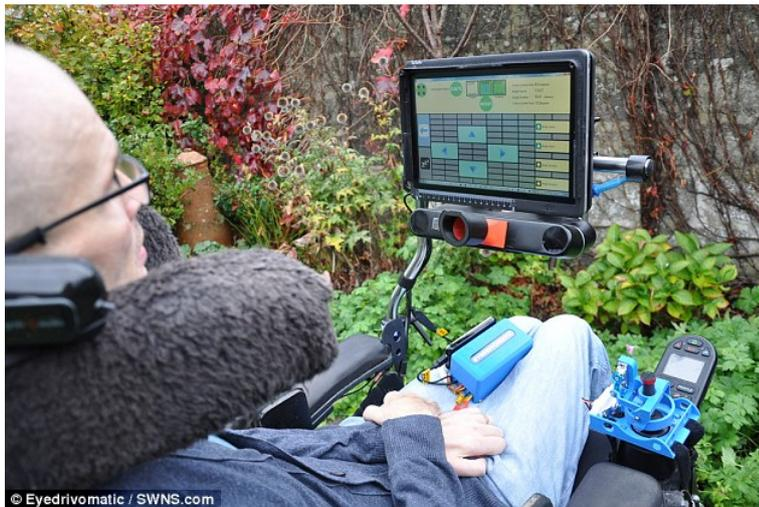
FIGURE 1.4.1 – Commande par oculométrie.
