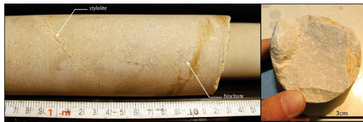
FIGURE 1.3 – Faciès du type de calcaire rencontré sur l'ensemble du forage MIGA. On trouve également un exemple de styloïte et de bioclaste observés dans ce forage, BAUDOY, [2017]
