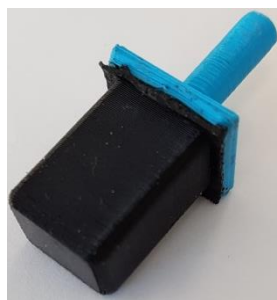
Figure II-27 : Photo d'un frotteur utilisé pour les essais tribologiques.
