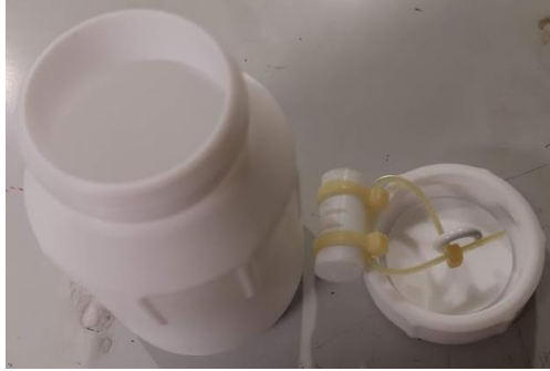
Figure II-4 : Photo du pot en Téflon avec un crochet intégré pour y suspendre les échantillons.
