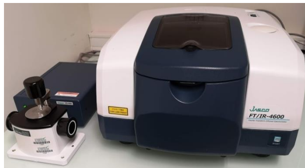
Figure II-13 : Appareil Infrarouge Jasco 4600 et son dispositif ATR à gauche.
