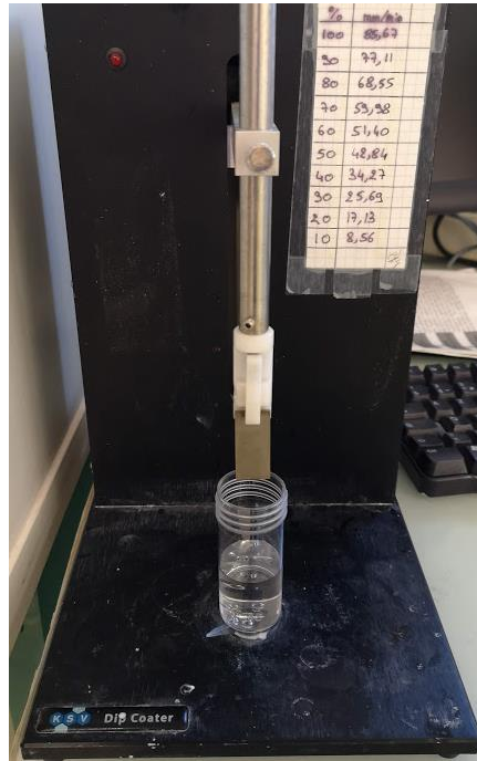
Figure II-2 : Photo du dip-coater utilisé pour réaliser les dépôts sol-gel.
