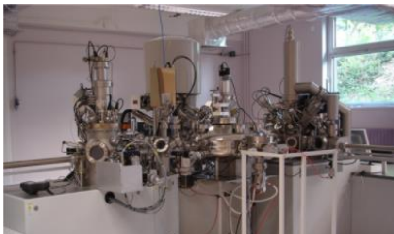
Figure II-12 : Plate-forme d'analyse XPS, TOF-SIMS et LEIS de l'Institut Chevreul.
