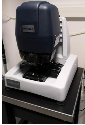
Figure II-6 : Appareil d'interférométrie utilisé.
