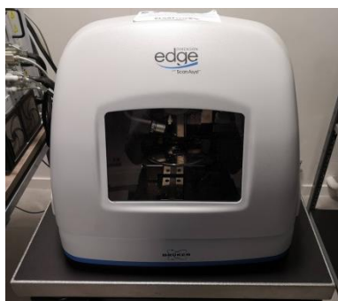
Figure II-10: Appareil d'AFM utilisé
