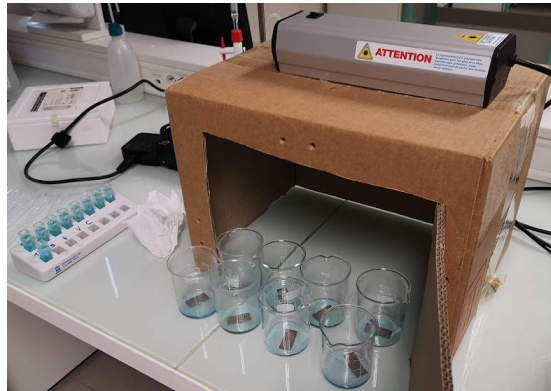
Figure II-26 : Photo d'illustration de la manipulation de suivi de dégradation du colorant en fonction du temps. Le prélèvement vient d'être fait et est placé dans les cuves à gauche sur la photo.
