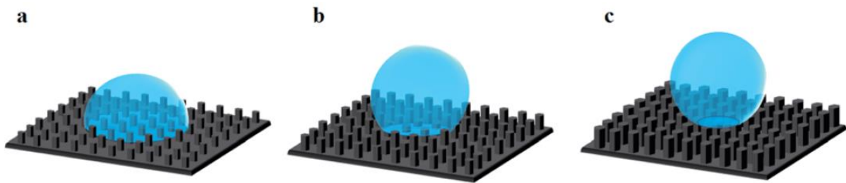
Figure III-7 : Effet de la densité d'aiguilles en fonction notamment de leur diamètre d'après Ghannam et al. [257]
