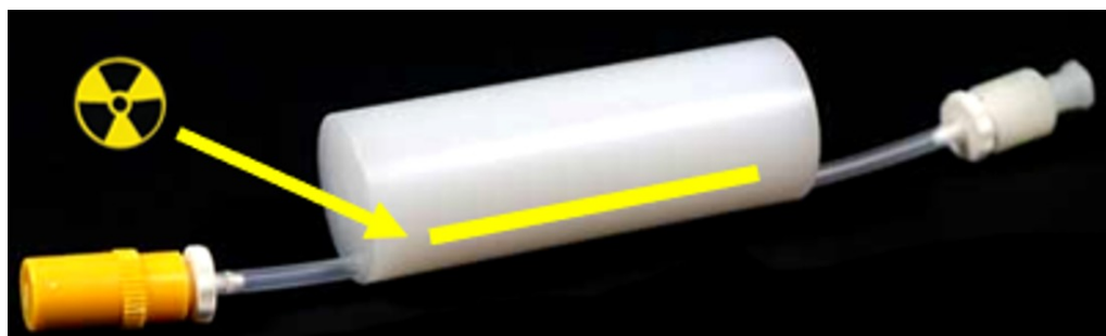
FIGURE 4.22 – Exemple de fantôme souris utilisé pour la mesure des taux de comptage selon le standard NEMA-NU4-2008. La source, symbolisée en jaune, est 10 mm plus courte que la longueur du fantôme.
