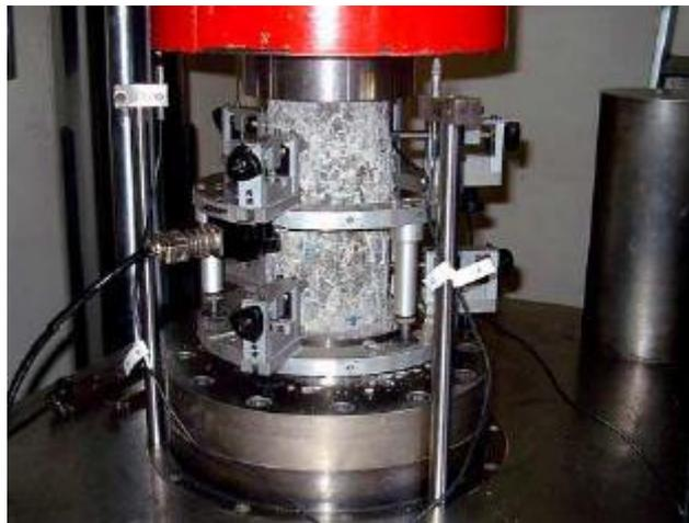
**Figure I-28** Montage de l'essai de compression du béton avec le dispositif des capteurs et de l'extensomètre [Nguyen, 2005]
