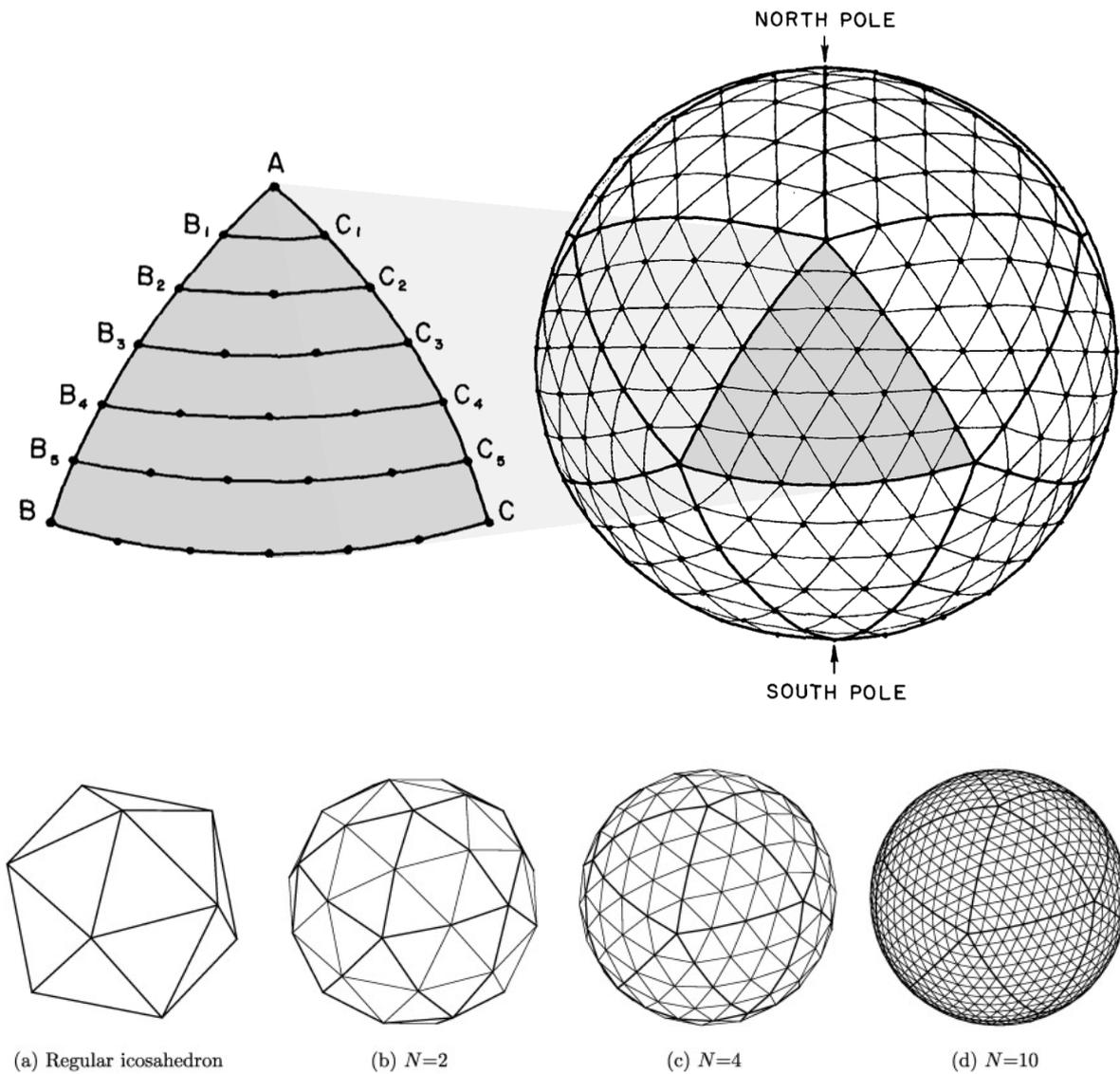
FIGURE 2.2 – En haut : méthode de raffinement de la grille icosaédrique pour  $N = 6$  dans l'un des triangles sphérique de l'icosaèdre et résultat obtenu après répétition de l'opération pour chacun d'entre eux (images extraites de Sadourny et al. (1968)). En bas : grilles obtenues pour différentes valeurs de  $N$  :  $N = 1$  en (a),  $N = 2$  en (b),  $N = 4$  en (c) et  $N = 10$  en (d).
