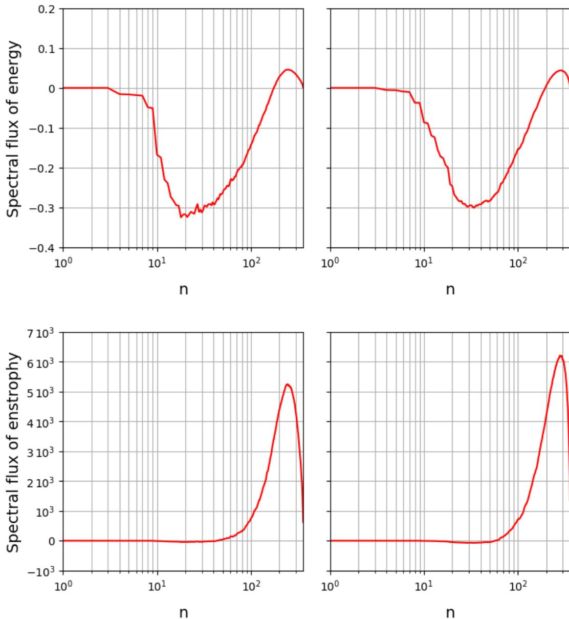
FIGURE 3.13 – En haut : flux spectraux d'énergie en fonction de  $n$  pour une dissipation modérée à gauche et une dissipation faible à droite. En bas : flux spectraux d'enstrophie en fonction de  $n$  pour une dissipation modérée à gauche et une dissipation faible à droite. Par convention, le flux spectral est calculé de sorte qu'il soit positif quand l'énergie est transférée des grandes vers les petites échelles et négatif quand l'énergie est transférée des petites vers les grandes échelles.
