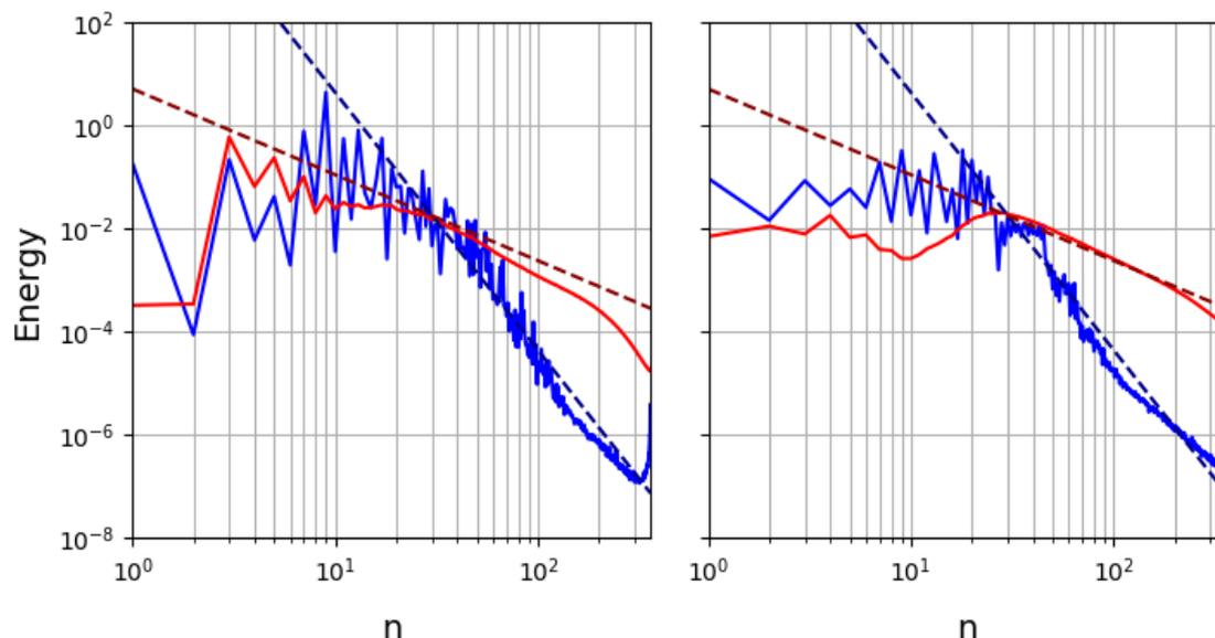
FIGURE 3.12 – Spectres d'énergie en  $J kg^{-1}$  de l'écoulement dans la troposphère pour une dissipation modérée à gauche et une dissipation faible à droite. La partie axisymétrique de l'écoulement est en bleu et la partie non-axisymétrique est en rouge. Les droites tiretées bleu sombre et rouge sombre représentent les pentes théoriques de  $-5$  et  $-5/3$  respectivement.
