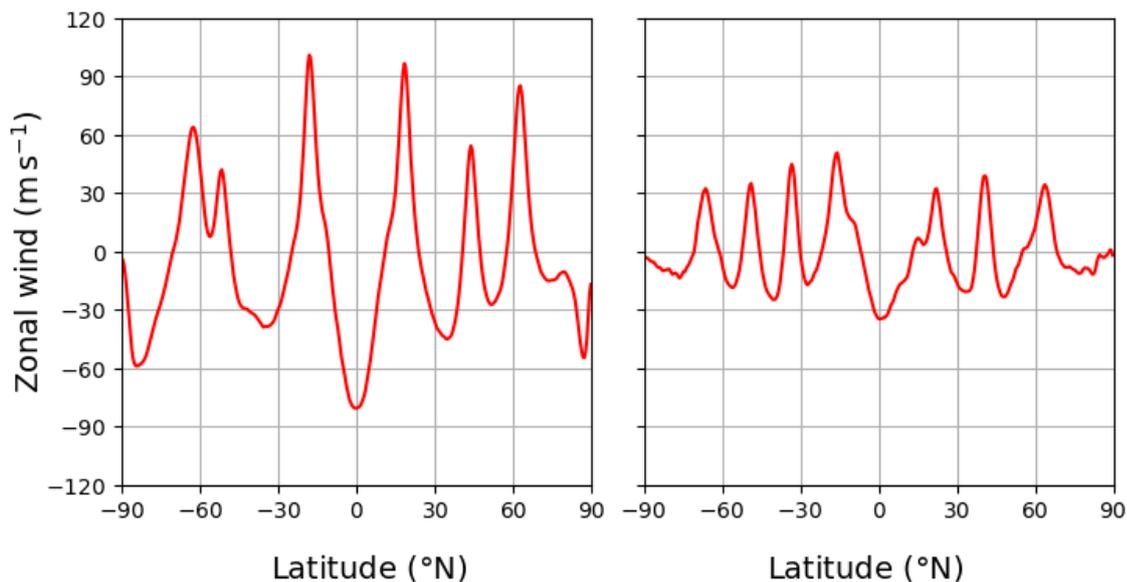
FIGURE 3.2 – Moyenne zonale du vent zonal en fonction de la latitude à  $p = 1 \text{ bar}$  et  $t = 60\,000$  jours joviens pour une dissipation modérée à gauche et une dissipation faible à droite. Les jets simulés sont moins nombreux et plus larges que les jets observés mais leurs vitesses sont du bon ordre de grandeur en valeur absolue (cf. figure 1.6). Le jet équatorial est rétrograde alors qu'il est prograde dans les observations.
