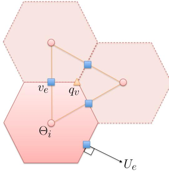
FIGURE 2.3 – Trois mailles hexagonales du GCM avec les centres  $i$  indiqués par des ronds rouges, les interfaces  $e$  indiqués par des carrés bleus et les sommets  $v$  indiqués par des triangles orange (figure extraite de Dubos et al. (2015)).
