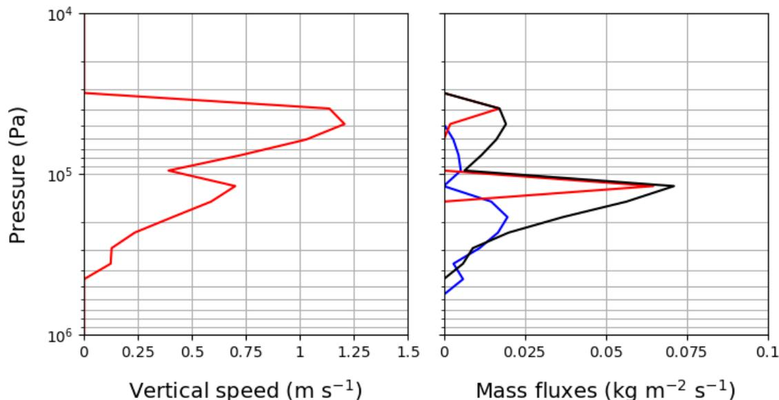
FIGURE 4.3 – Structure verticale de la vitesse du panache à gauche et des flux de masse à droite après 100 jours joviens de simulation avec  $\beta = 0,9$ ,  $a = 0,9$  et  $b = 10^{-4} \text{ m}^{-1}$ . L'entraînement est en bleu, le déentraînement en rouge et le flux de masse vertical en noir.
