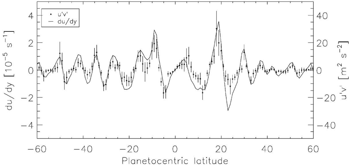
FIGURE 1.9 – Mesures du cisaillement méridien du vent zonal ( $du/dy$ ) et du transport de moment par les eddies ( $u'v'$ ) sur Jupiter par cloud tracking à partir des observations de la sonde Cassini (image extraite de Salyk et al. (2006)).
