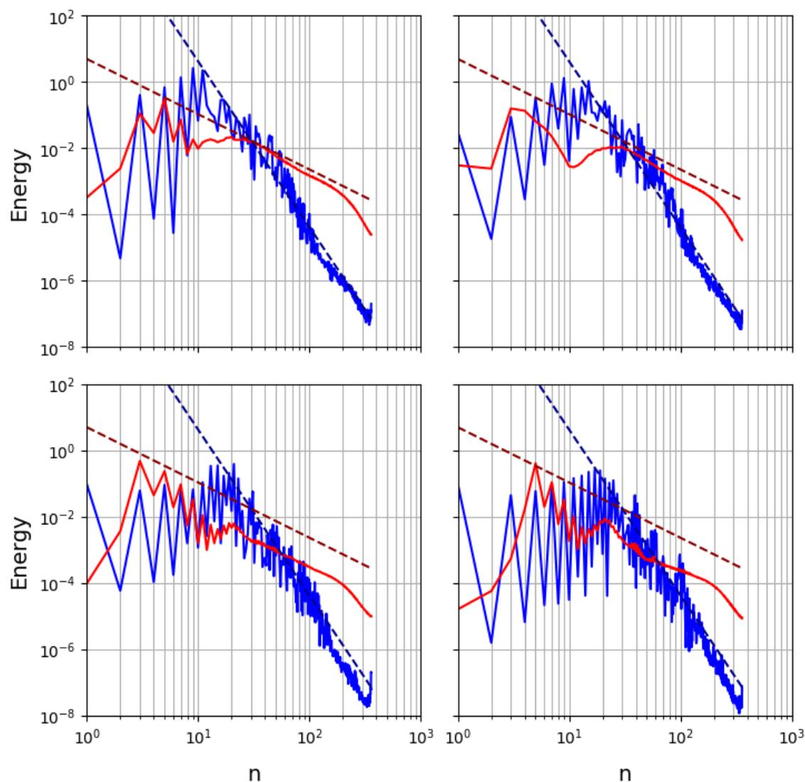
FIGURE 5.15 – Spectres d'énergie en  $J\text{ kg}^{-1}$  de l'écoulement dans la troposphère pour 0 SA (en haut à gauche), 1 SA (en haut à droite), 3 SA (en bas à gauche) et 5 SA (en bas à droite). La partie axisymétrique de l'écoulement est en bleu et la partie non-axisymétrique est en rouge. Les droites tiretées bleu sombre et rouge sombre indiquent des pentes de  $-5$  et  $-5/3$  respectivement. Elles sont identiques aux droites décrites dans la section 3.2.2 du chapitre 3.
