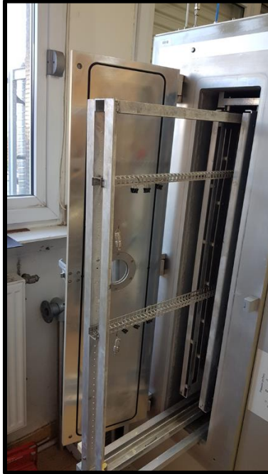
Figure 41: Photo de l'enceinte plasma basse pression Europlasma.
