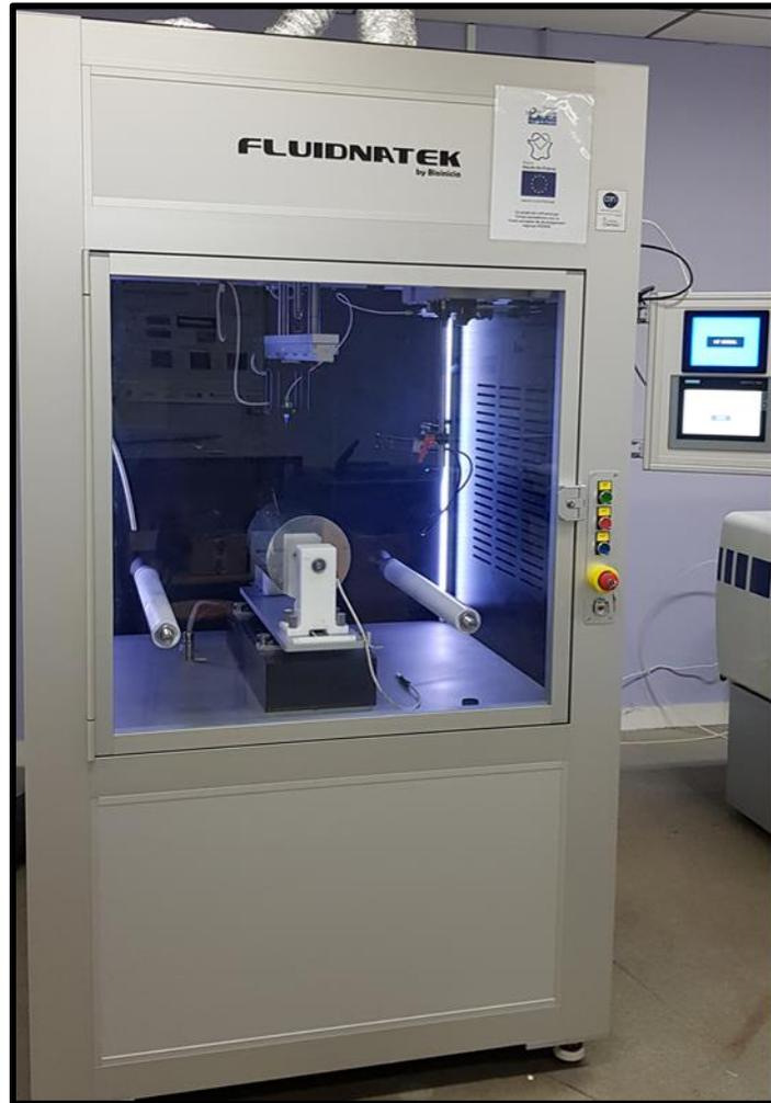
*Figure 40: Photo de l'appareil electrospinning LE-500 Fluidnatek provenant de Bioinicia*
