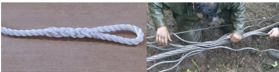
FIGURE 4.11 – Différentes applications de l'épissure. Une corde de marine est épissée pour former une boucle (gauche). Réparation du câble du télésiège du Col du Rousset par épissure [99] (droite).
