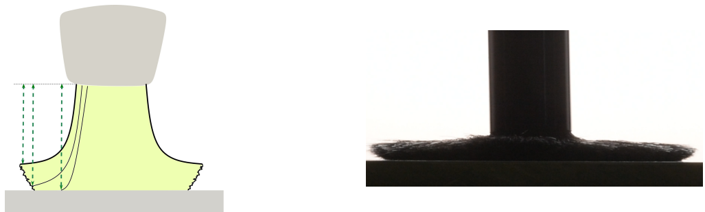
FIGURE 2.12 – Valeur de l pour différents poils d'un pinceau. Trois valeurs de l_i sont représentées pour trois fibres i positionnés plus ou moins profondément à l'intérieur du pinceau. Une photographie d'un pinceau est représentée pour comparaison.
