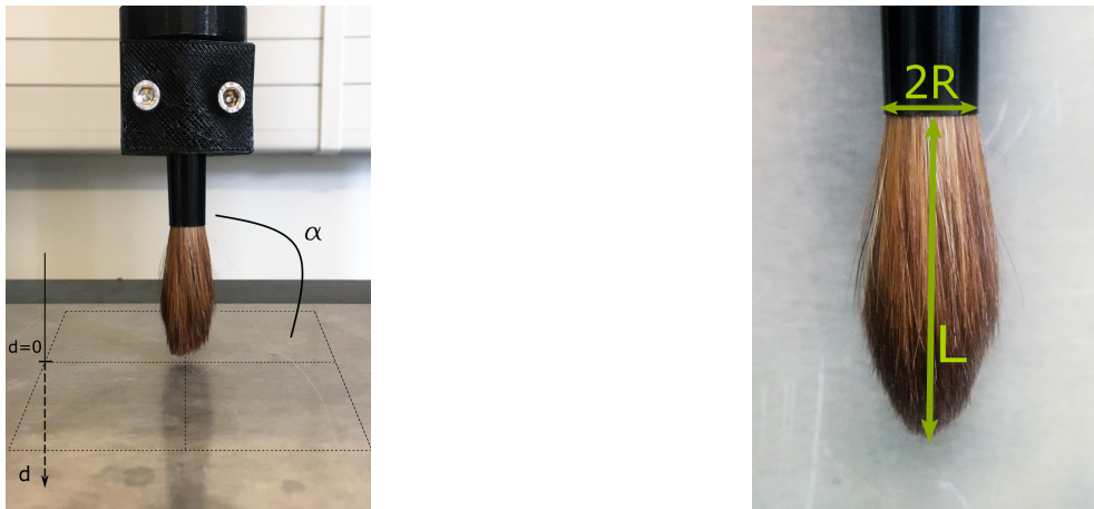
FIGURE 2.1 – (Gauche) Dispositif expérimental. Le pinceau est fixé par un mors dans la machine de force de traction et comprimé contre une surface plane en aluminium. La distance d est le déplacement du mors, qui est nul au contact du pinceau avec la surface et qui croît quand le pinceau se déplace vers le bas. (Droite) Dimensions d'un pinceau. On mesure le diamètre D = 2R au niveau de la virole, et la longueur des poils L depuis la virole jusqu'à la pointe.
