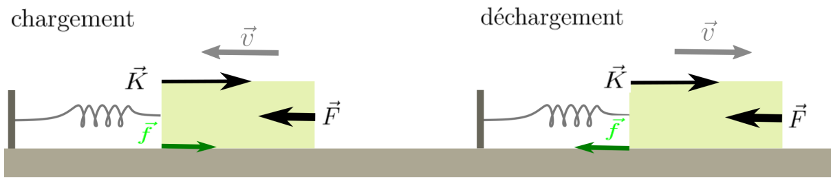
FIGURE 2.5 – Schéma de la compression d'un système ressort-patin frottant. Le vecteur vitesse \vec{v} indique le sens de déplacement du patin, \vec{K} est la force de rappel du ressort, \vec{F} la force exercée par l'utilisateur, et \vec{f} la force de frottement entre le patin et la surface, qui s'oppose au mouvement du patin.
