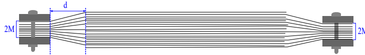
FIGURE 1.7 – Schéma d'un modèle de feuilles entremêlées. Chaque mors, constitué de deux plaques métalliques assemblées par deux vis chacune, enserre 2M . La distance d est la distance de séparation entre les feuilles. On notera d_0 la valeur de d avant que l'expérience ne commence. L'assemblage est ici représenté horizontalement, mais il est installé verticalement dans la machine de traction, comme illustré à la figure 1.6 (gauche).
