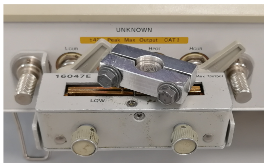
FIGURE 2.39 – Moyen de mesure de la capacité de jonction d'une diode press-fit
