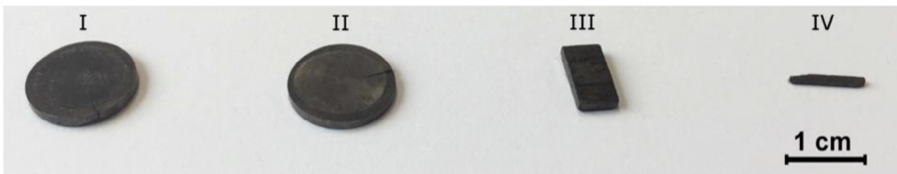
Figure 1-23 : Image optique d'aimants permanent composés de NBs de diamètre 10,9\text{ nm} compactés à 300\text{ MPa} , 180^\circ\text{C} (I), 450\text{ MPa} , 180^\circ\text{C} (II), 1\text{ GPa} , température ambiante (III), et de diamètre 28,3\text{ nm} et compacté à 450\text{ MPa} , 180^\circ\text{C} (IV) (issu de [55])
