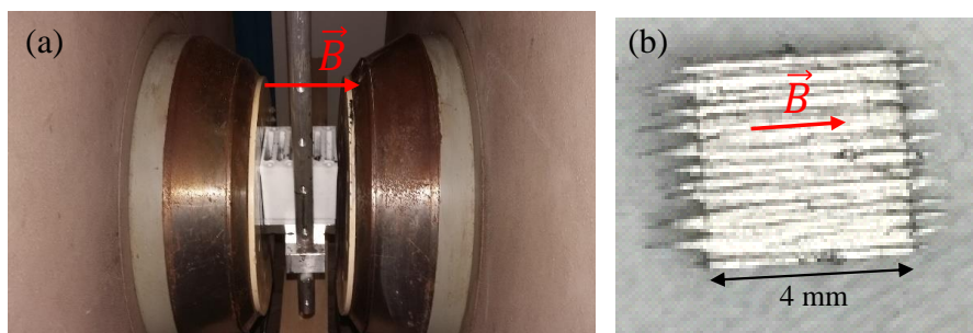
Figure 2-17 : Photographie (a) d'un moule placé au sein d'un électroaimant générant une induction magnétique \vec{B} et (b) d'un alignement obtenu dans la direction du champ magnétique appliqué sur une puce de Si
