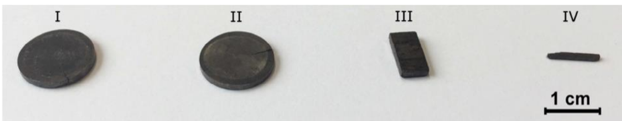
Figure 1-23 : Image optique d'aimants permanent composés de NBs de diamètre 10,9 nm compactés à 300 MPa, 180 °C (I), 450 MPa, 180 °C (II), 1 GPa, température ambiante (III), et de diamètre 28,3 nm et compacté à 450 MPa, 180 °C (IV) (issu de [55])
