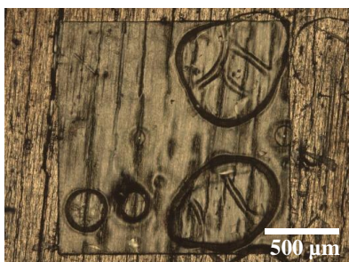
(1) Dépôt résine et insolation
