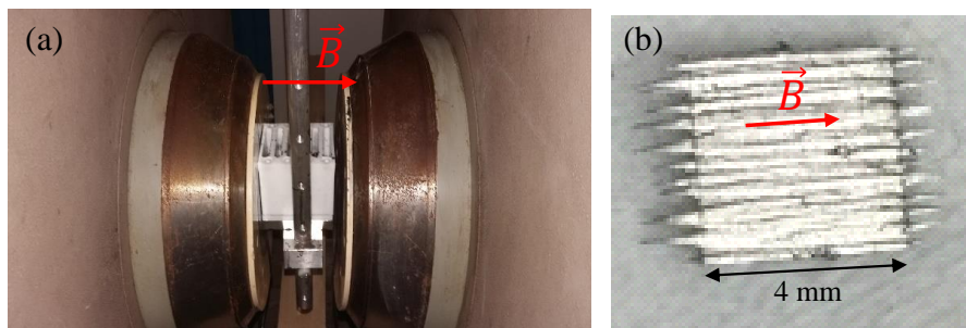
Figure 2-17 : Photographie (a) d'un moule placé au sein d'un électroaimant générant une induction magnétique \vec{B} et (b) d'un alignement obtenu dans la direction du champ magnétique appliqué sur une puce de Si
