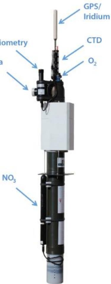
**Figure 7.** Photographie d'un flotteur BGC-Argo équipé de six capteurs physiques et biogéochimiques (Température, Salinité et Pression : CTD ; Concentration en dioxygène : O<sub>2</sub> ; concentration en chlorophylle *a* : Chla ; coefficient de rétrodiffusion particulaire : b<sub>bp</sub> ; concentration en nitrates : NO<sub>3</sub> ; et éclairement descendant : « radiometry »). *Source :* Roemmich *et al.* (2019).
