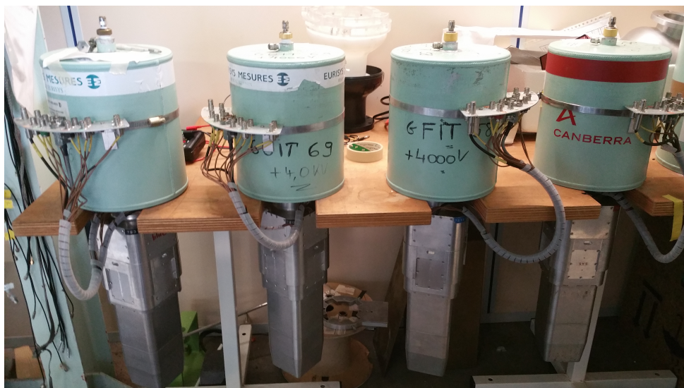
FIGURE 2.9 – Quatre HPGe clovers sur le banc de test. Ils sont reconnaissables à la forme carrée de leur capot en aluminium.
