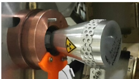
FIGURE 2.2 – À gauche : Photographie de la cible de ^{nat}\text{Th} qui a été utilisée lors de la campagne \nu -Ball. Elle est accolée à l'extrémité de la source de neutrons LICORNE. À droite : Photographie de la cible d' ^{238}\text{U} placée au centre du spectromètre \nu -Ball.
