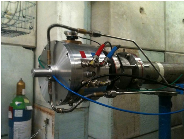
FIGURE 2.3 – Photographie de la source de neutrons LICORNE placée à l'extrémité de la ligne de faisceau.
