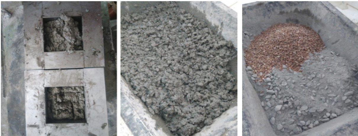
Figure 48. Mise en œuvre des bétons composites TESC-S
