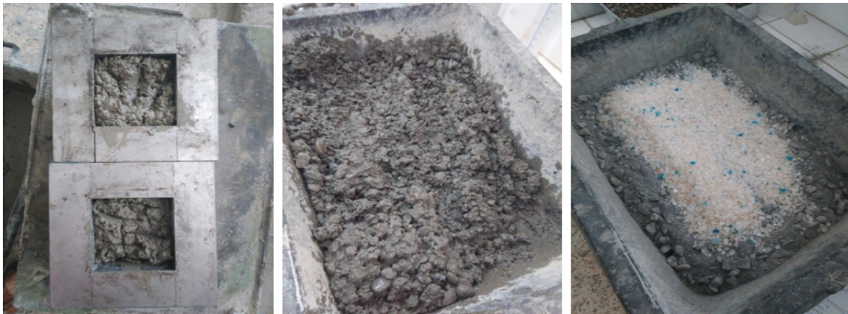
Figure 47. Mise en œuvre des bétons composites TESC-SG
