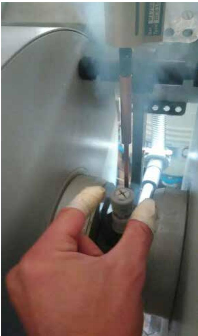
Photo 26 : Cavité de mesure du spectromètre ESR.
