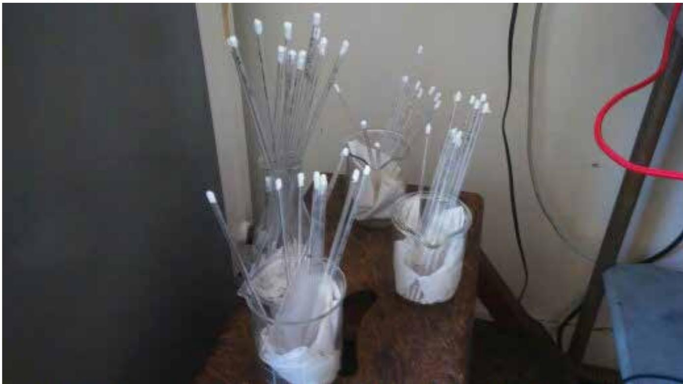
Photo 23 : sédiments séparés en aliquotes avant d'être analysés au spectromètre ESR.
