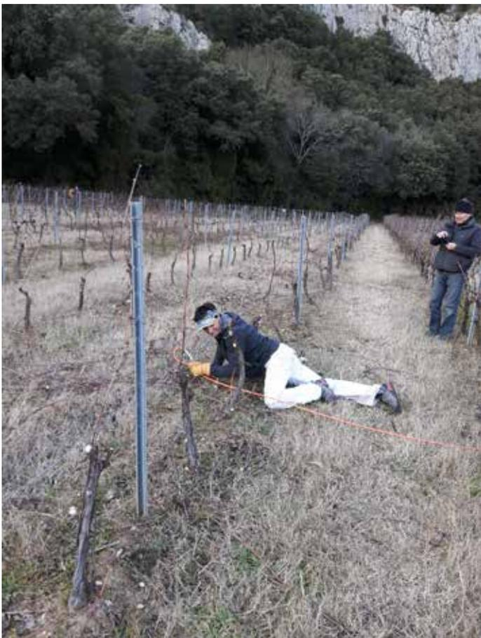
Photo 16 : Passage des cables et des électrodes sous les piquets de vigne. Crédits : A. Revil, 2019.
