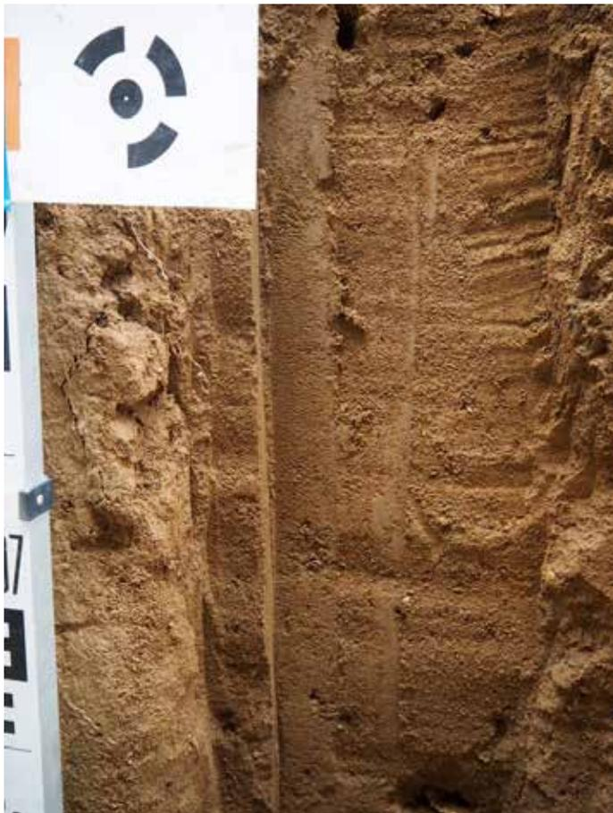
Photo 21 : Tranchée artificielle à l'amont de la Combe d'Arc réalisée lors de l'Opération Grand Site. Des galets étaient visibles à la base de la tranchée, environ 5 m sous le niveau de la route. Crédits : K. Génuite, 2018.
