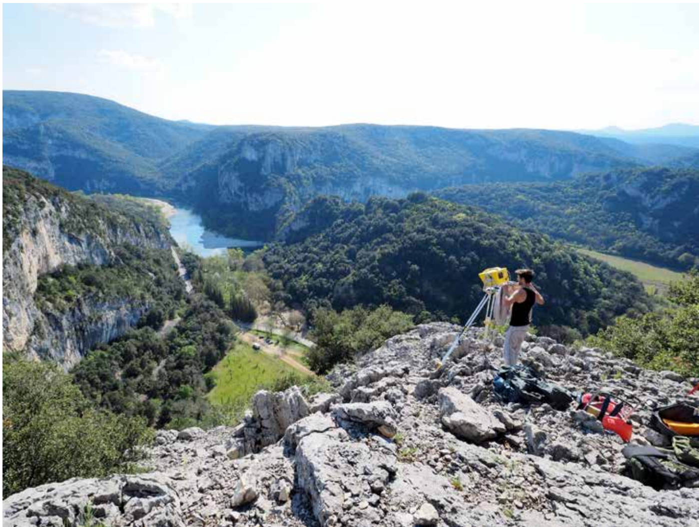
Photo 5 : Acquisition par LiDAR longue portée de la partie aval du méandre de la Combe d'Arc. Crédits : P. Génuite, 2017.
