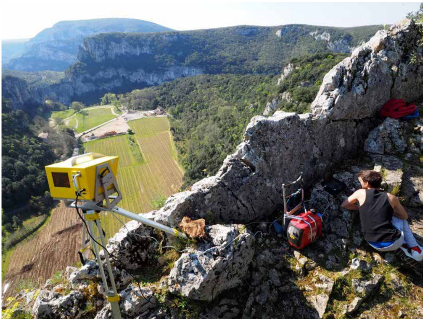
Photo 3 : Acquisition par LiDAR longue portée de la partie amont du méandre de la Combe d'Arc. Crédits : P. Génuite, 2017.
