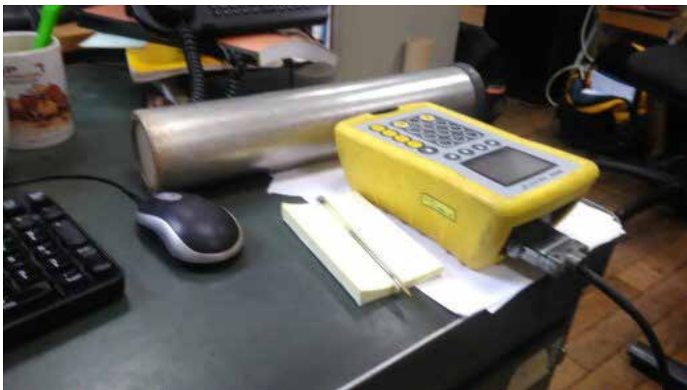
Photo 24 : Spectromètre de terrain permettant d'évaluer la dose d'irradiation in situ des sédiments, un paramètre majeur dans le calcul de l'âge d'enfouissement par spectrométrie ESR. Crédits: K. Génuite, 2018.
