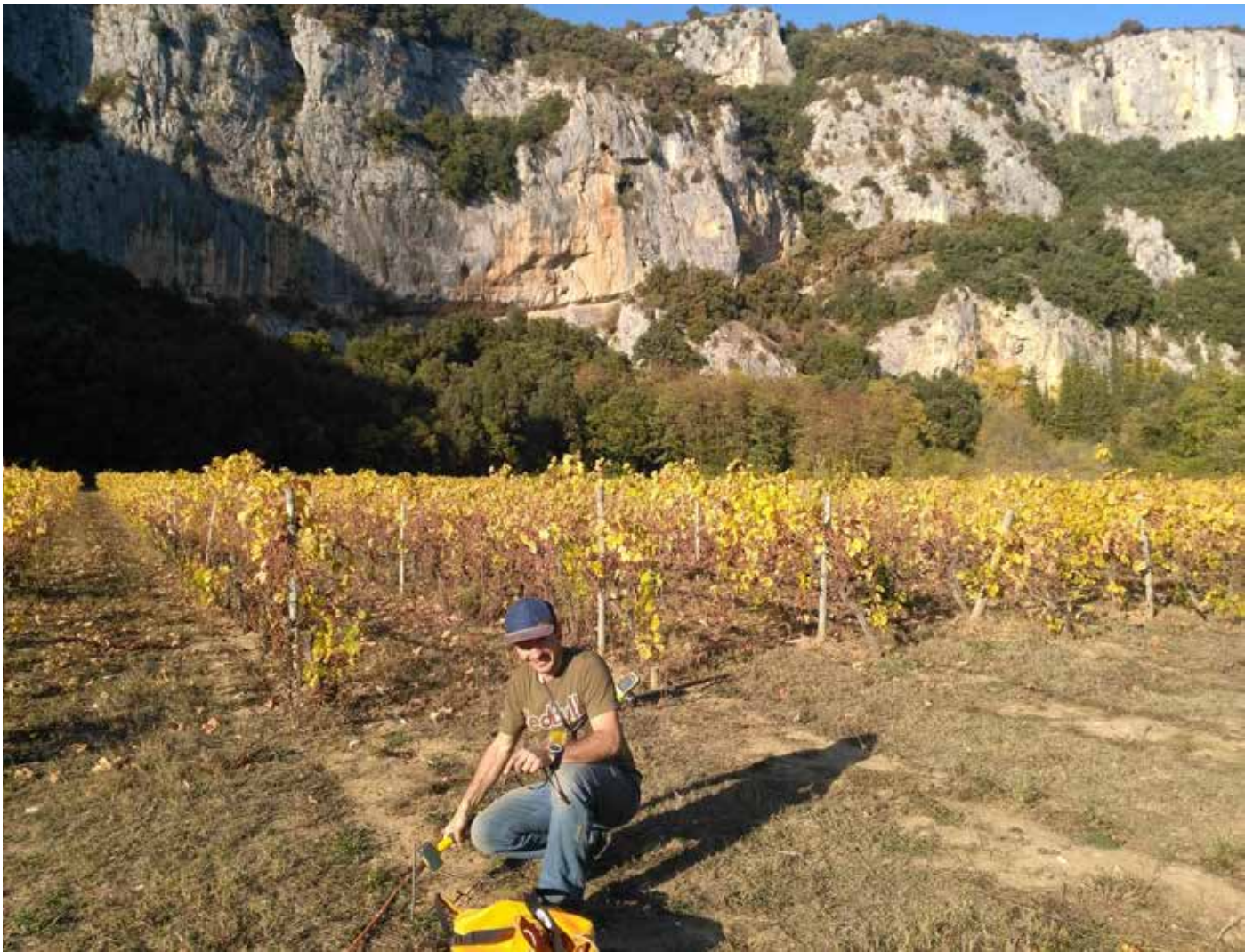
Photo 12 : Placement d'une électrode le long d'un câble, près d'un take-out . Campagne de géophysique 2017. Crédits : K. Génuite, 2017.
