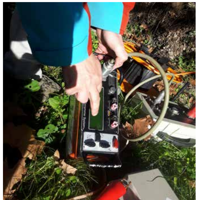
Photo 14 : Outil de mesure de la résistivité électrique : ABEM SAS 4000. Crédits : L. Ravanel, 2019.
