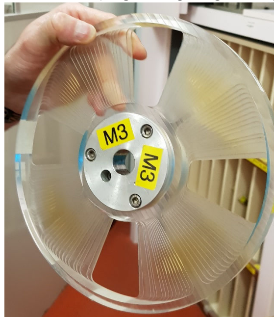
Figure 38. Roue de modulation avec des secteurs de différentes épaisseurs permettant l'obtention d'un SOB en mode DS.
