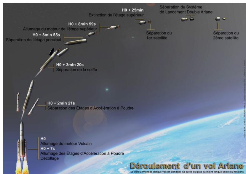
Figure 1.6 : Déroulement d'un vol d'Ariane 5 jusqu'à largage des satellites (image CNES)
