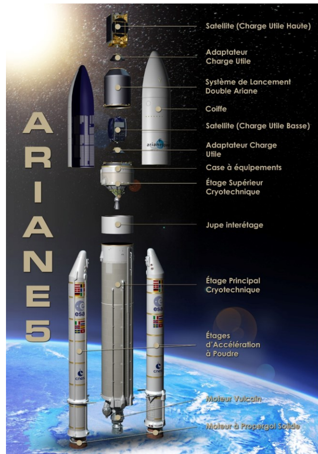
Figure 1.7 : Architecture générale du lanceur Ariane 5 ECA (image CNES)
