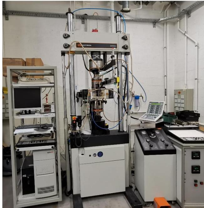
*Figure 64 : Machine électromécanique Instron 8562 utilisée pour les essais (cellule de charge de capacité dynamique de 100kN).*
