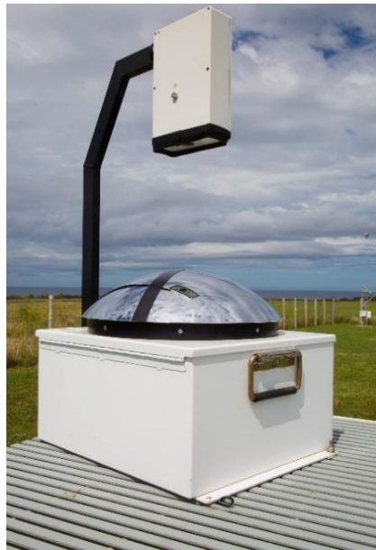
Figure III-3: Dispositif TSI, composé d'un miroir hémisphérique convexe avec une caméra au-dessus. Le miroir contient une bande d'ombre de suivi du soleil pour protéger la caméra des reflets du soleil.
