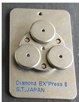
FIGURE 4.4 – Photo prise d'une cellule diamant après écrasement d'IDPs en salle blanche ISO 7.
