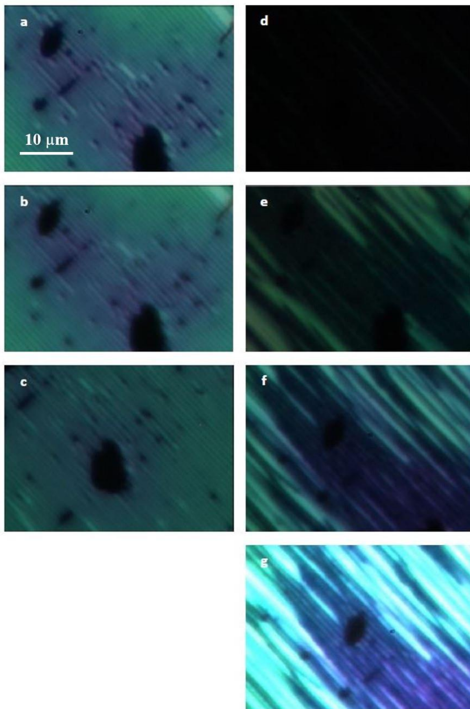
FIGURE 6. 7 – Images de microscopie optique en réflexion entre polariseur et analyseur croisés de l'échantillon polymérisé à 23,5°C, de concentration 10 wt-% en monomère : (a) dans la phase Sm-A à 23°C, (b) dans la phase nématique à 27°C et (c) à 29°C, (d) dans la phase isotrope à 42°C, et en refroidissant (e) à 38°C et puis (f) à 23°C. (g) est exactement l'image (f) en changeant le contraste et la luminosité. En jouant sur ces deux paramètres, nous avons pu voir des stries fines de couleur bleu foncée, d'épaisseur d'environ 200 nm qui sont restées intactes, contrairement aux stries deux fois plus épaisses de couleur verte.
