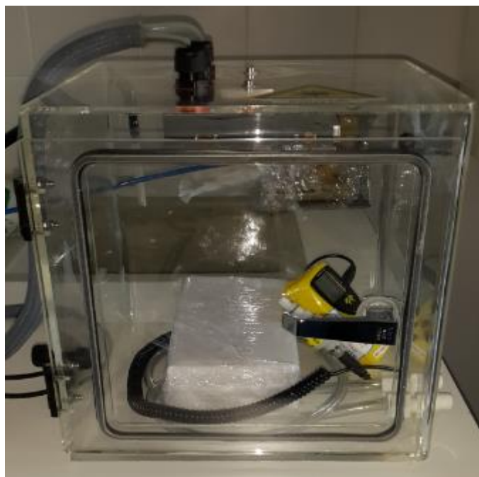
FIGURE 2. 8 – Boîte « maison » montée pour la polymérisation sous vide.
