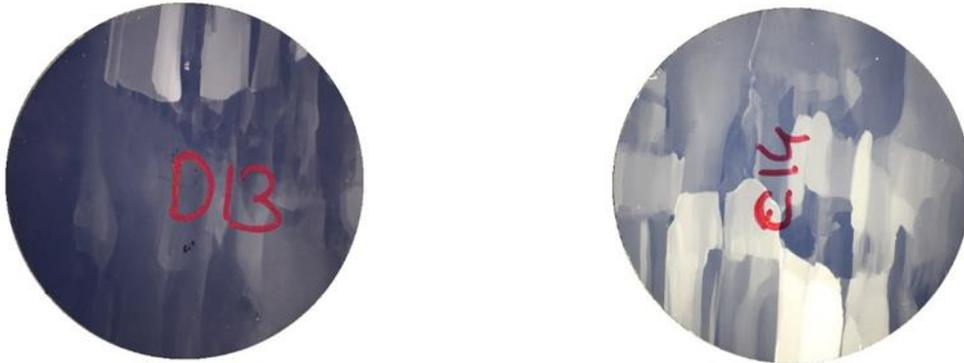
Figure II-39 : Exemple de photographies en polarisation croisée de tranches en pied (à gauche), et tête (à droite) d'une même boule.
