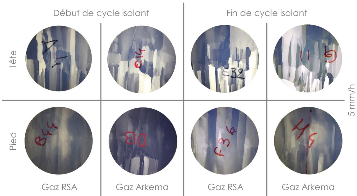
Figure IV-1 : Photographies en polarisation croisée pour les différentes conditions de cristallisation en Verneuil.
