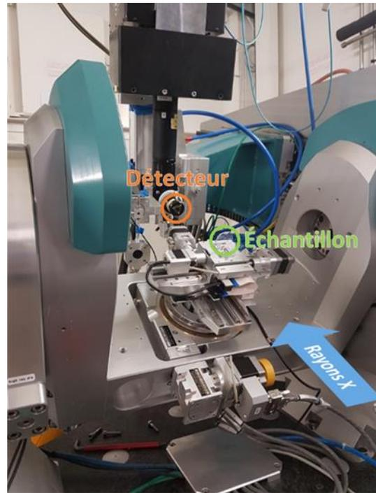
Figure IV-26: Photographie de l'expérience de Rocking Curve Imaging.
