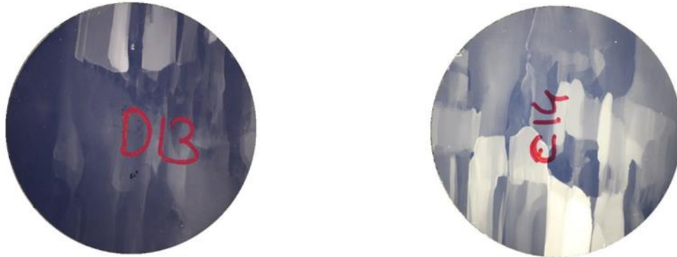
Figure II-39 : Exemple de photographies en polarisation croisée de tranches en pied (à gauche), et tête (à droite) d'une même boule.
