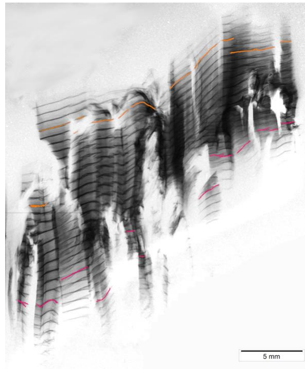
Figure IV-21 : Image en topographie du plan \{10\bar{1}8\} de l'échantillon Verneuil en début de cycle isolant, tête de boule et vitesse de cristallisation lente. Deux sections ont été suivies, ici en couleurs.
