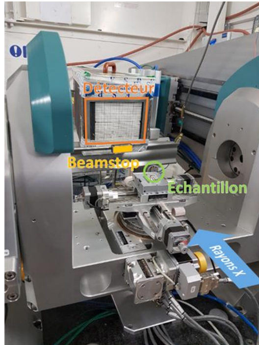
Figure IV-7 : Photographie de l'expérience de topographie.
