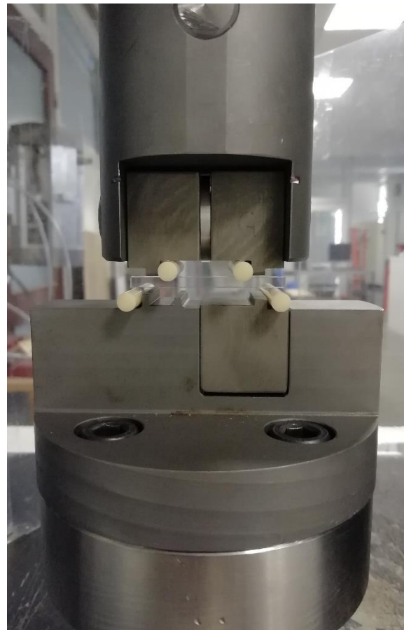
Figure II-15 : Photographie d'un essai de flexion quatre points [Bouteille 2019].
