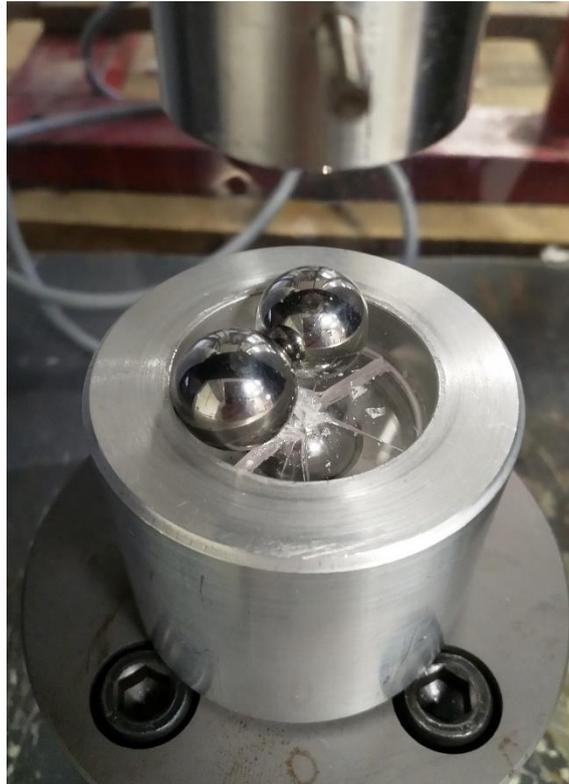
Figure II-20: Photographie d'un essai de flexion bille sur trois billes.
