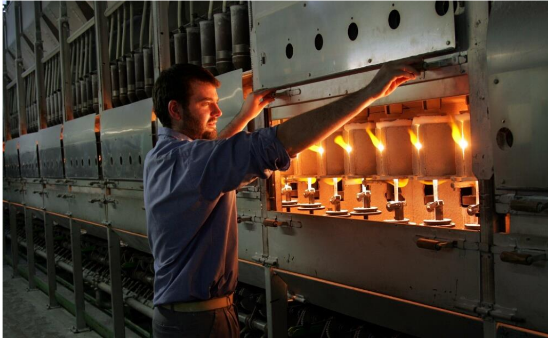
Figure II-1 : Photographie d'une rampe de cristallisation Verneuil composée de 45 fours.
