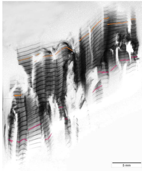
Figure IV-21 : Image en topographie du plan  $(\bar{1}018)$  de l'échantillon Verneuil en début de cycle isolant, tête de boule et vitesse de cristallisation lente. Deux sections ont été suivies, ici en couleurs.
