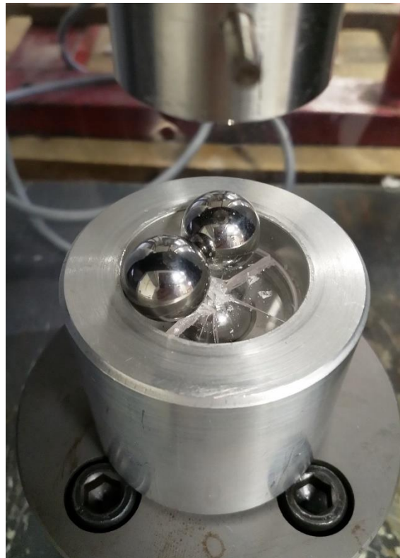
Figure II-20: Photographie d'un essai de flexion bille sur trois billes.
