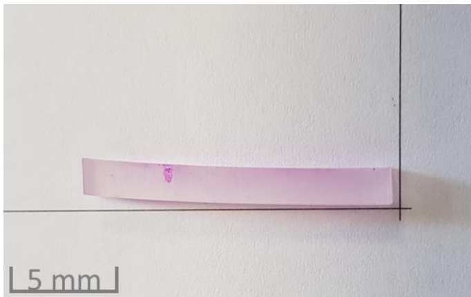
Figure II-29 : Photographie d'une éprouvette pour laquelle le sciage a dévié.
