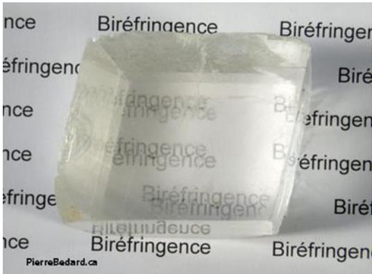
Figure I-7 : Exemple de cristal biréfringent, ici de la calcite photographiée par l'École Polytechnique de Montréal.
