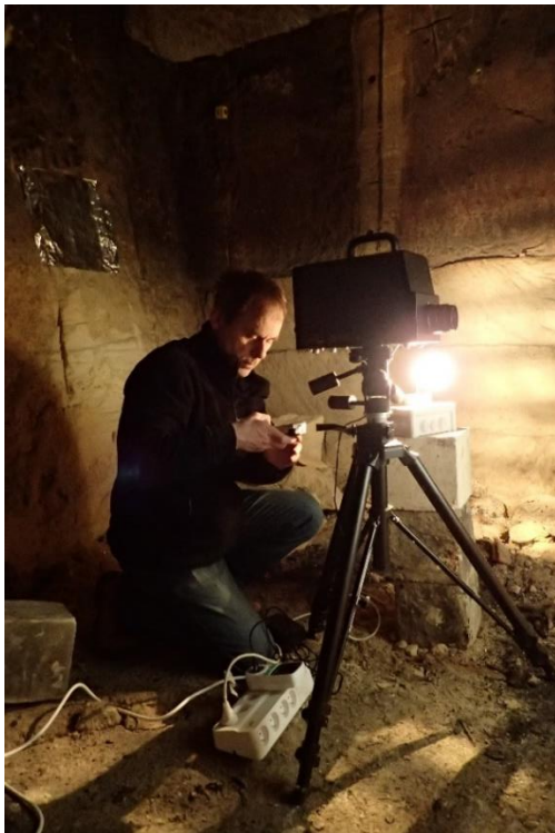
Figure 47 : Petite galerie, installation du spectroradiomètre (cl. D. Lacanette).
