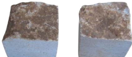
Figure 40 : Échantillons calcaires de Leye
