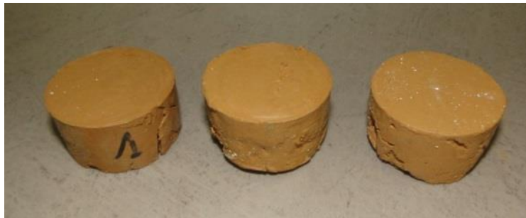
Figure 103 : Éprouvettes issus du bloc d'argile (CSTB).
