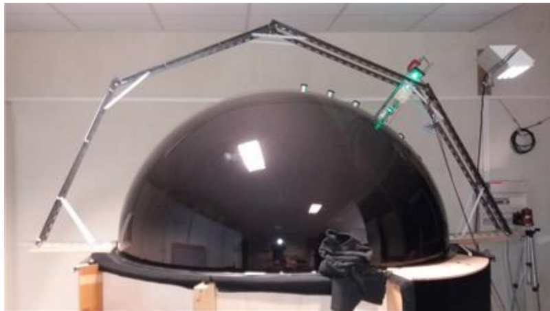
Figure 37 : Banc de mesure des propriétés de réflexion de surfaces du CSTB de Nantes (cl. S. Carré).
