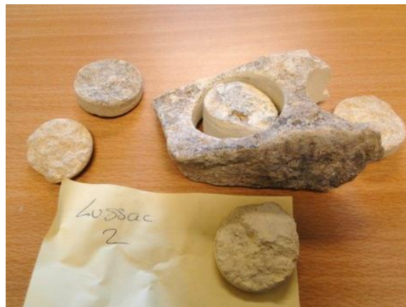
Figure 98 : Carottage en cours d'un échantillon du site de Cussac (CSTB).
