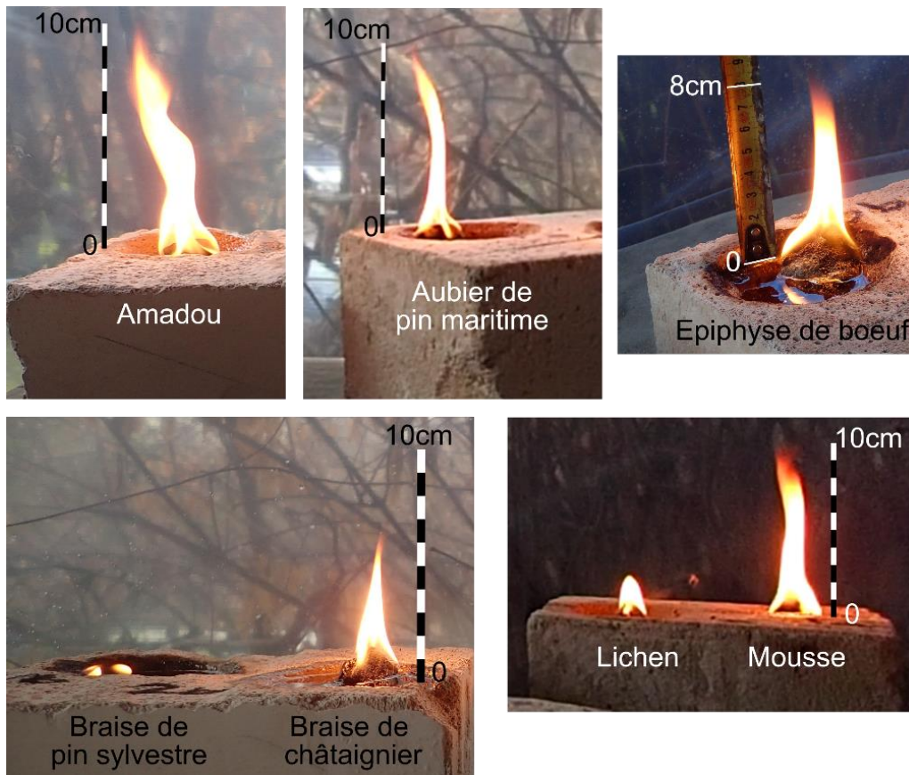
Figure 64 : Hauteurs maximales des flammes produites par différentes mèches naturelles (cl. A. Jouteau, C. Ferrier).
