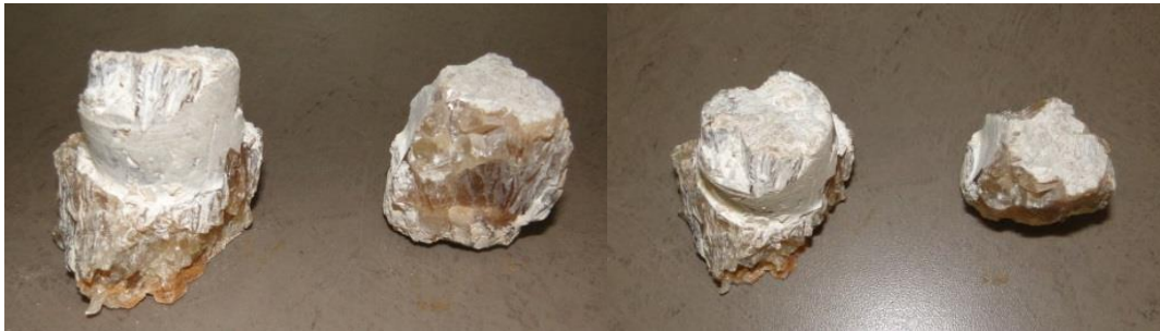
Figure 102 : Tentatives de carottage d'échantillons dans de la calcite (CSTB).
