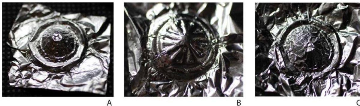
Figure 268 : Production expérimentale de pièces au repoussé au moyen de la salière de Speluncatu (A et C) et Murtoli (B), (Graziani et al. 2014, p. 453, fig.4)
