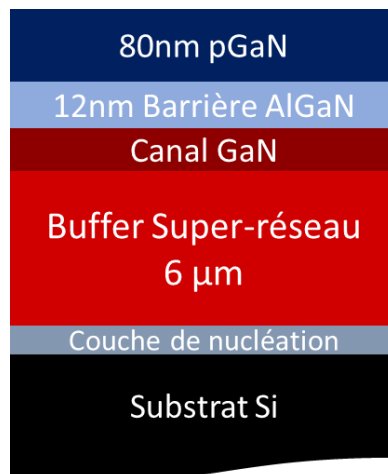
Figure 2.30 : Représentation schématique de la structure avec un buffer SL à cap p-GaN.
