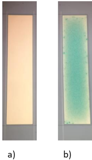
Figure 1.21 : Contact Ti/Al/Ni/Au sans (a) et avec (b) effet de « peste pourpre ».
