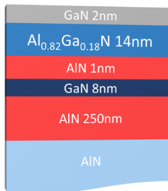
Figure 5.7 : Schéma de structure AlGaIn/AlN sur substrat AlN.
