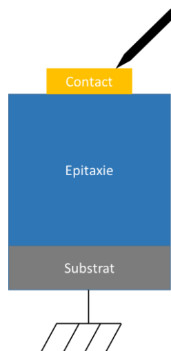
Figure 1.28 : Schéma de la mesure de claquage vertical d'une hétérostructure à base de GaN.
