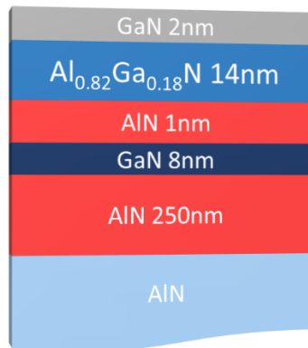
Figure 5.7 : Schéma de structure AlGaN/AlN sur substrat AlN.
