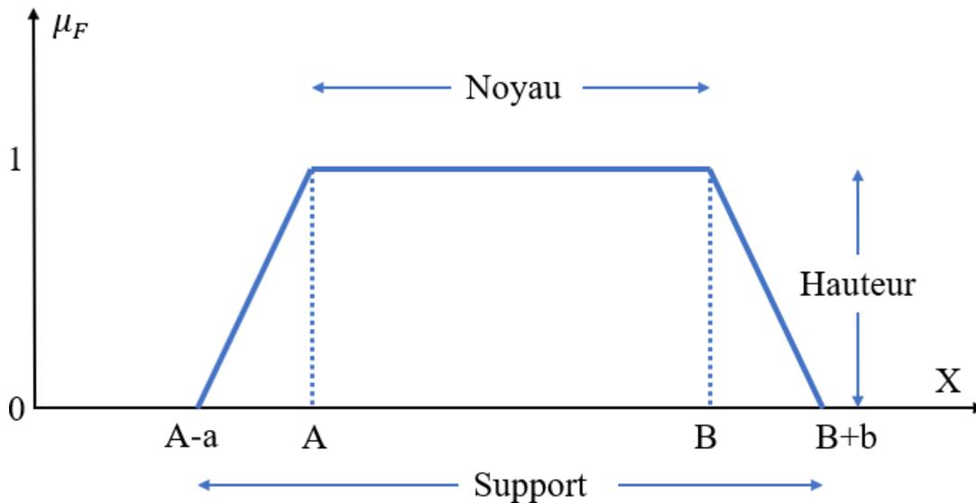
FIGURE 1.1 – Exemple de fonction d'appartenance trapézoïdale
