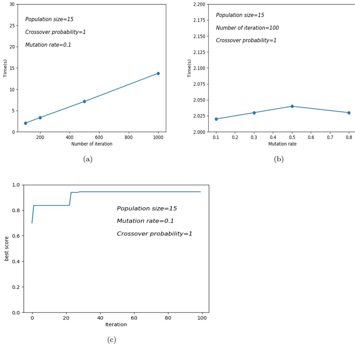
FIGURE 5.9 – Évolution de l’algorithme génétique (a) Temps d’exécution en fonction du nombre d’itérations (b) Temps d’exécution en fonction du taux de mutation (c) Taux de réussite par rapport au nombre d’itérations
