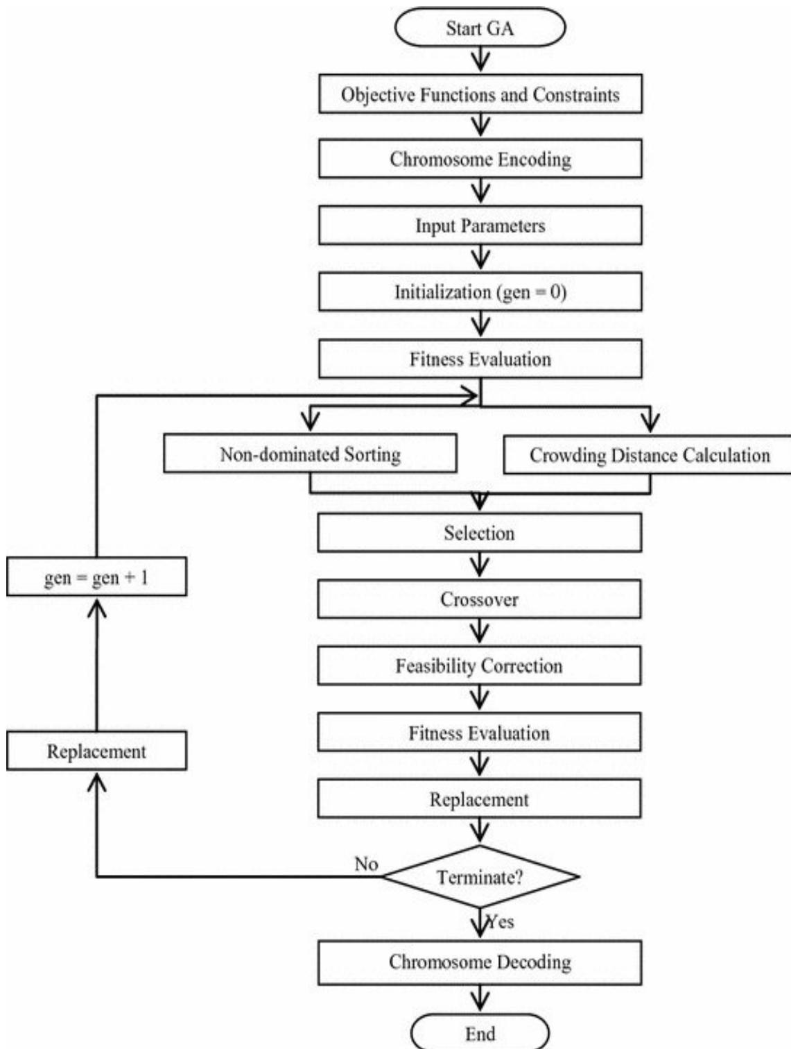
FIGURE 5.7 – Principe de fonctionnement de NSGA II
