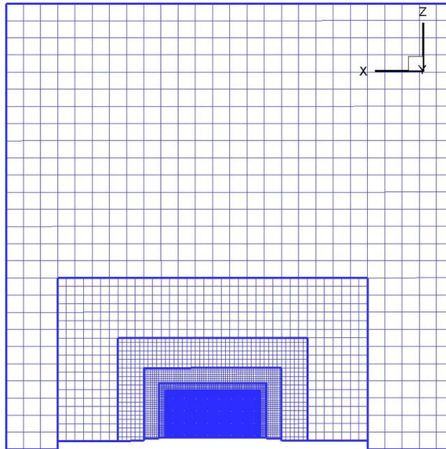
FIGURE 1.4: CARTFLOW - Coupe 2D d'un maillage octree
