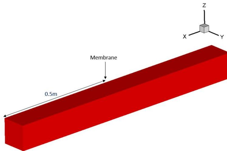
FIGURE 4.29: Géométrie 3D du tube à choc
