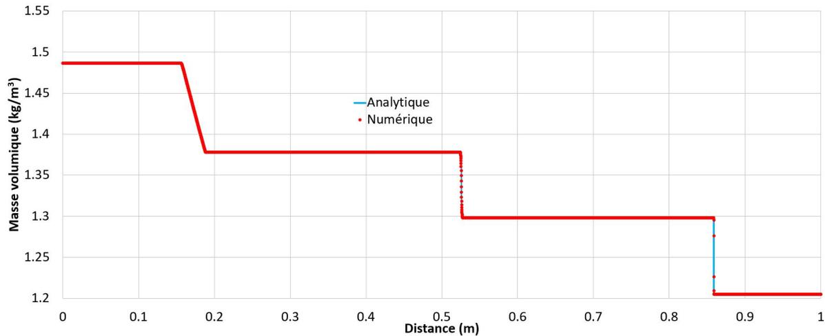
FIGURE 2.3: Masse volumique en fonction de la distance
