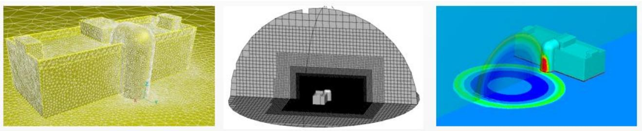
FIGURE 1.5: Simulation d'explosion près d'un bâtiment (METAS)
