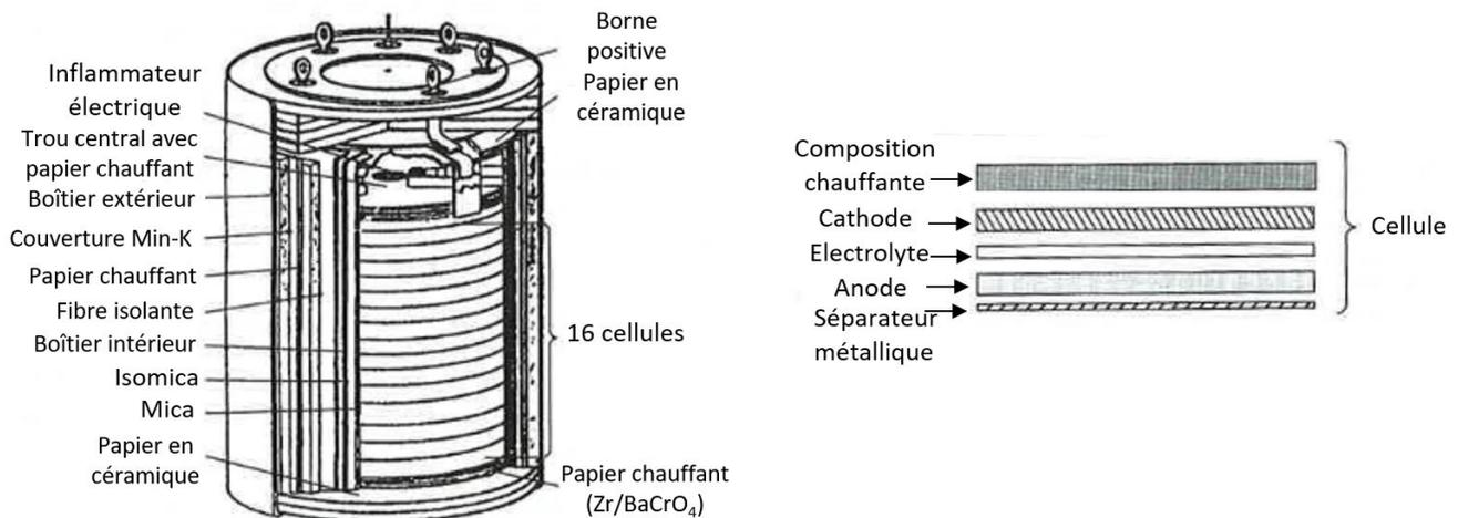
FIGURE 3.5: Représentation schématique d'une pile thermique [43]
