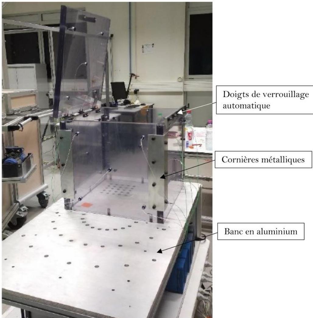
FIGURE 4.35: Enceinte expérimentale de K. Gault [52]
