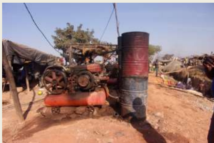
c. Nouveau type de motopompe à gasoil importé de Chine et amélioré par les orpailleurs pour augmenter la capacité en carburant avec deux barriques de gasoil. Il est plus coûteux que les précédents et de plus en plus utilisé. Cliché : Edith Sawadogo, novembre 2019
