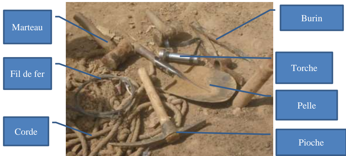
Photo 8: matériel de fonçage
