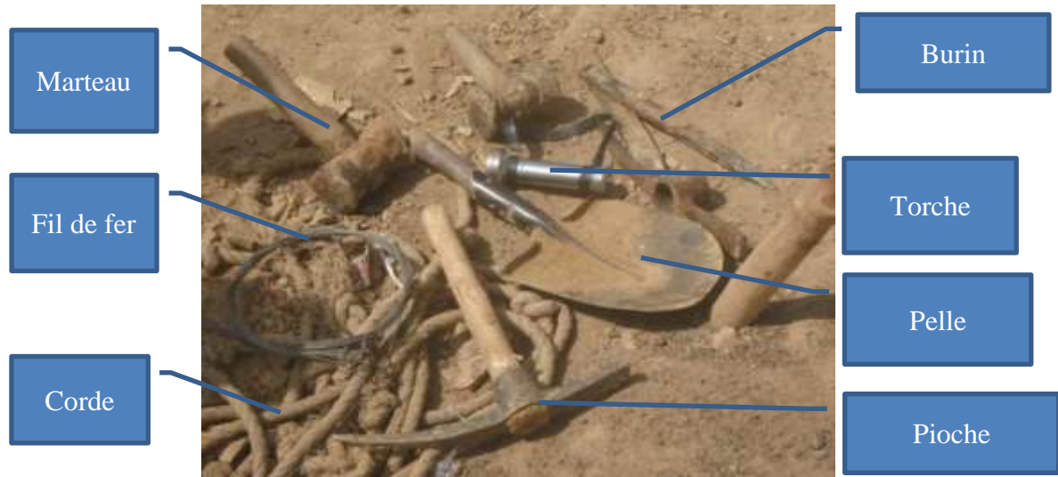
Photo 8: matériel de fonçage
