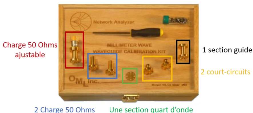
Figure I-15 : Kit de calibration en guide fabriqué par la société OML, INC, de Rohde & Schwarz
