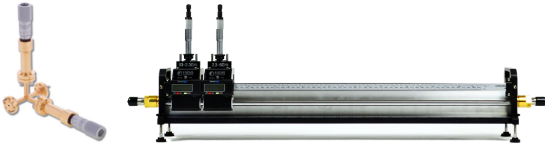
Figure III-5 : Illustration des tuners mécaniques multi-stubs : (Gauche) Tuner mécanique avec jonction en T – (Droite) Tuners mécaniques multi-stubs dans le même plan.
