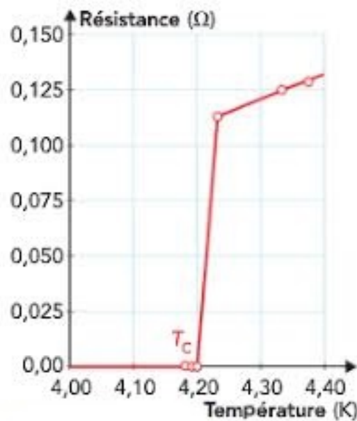
FIGURE 1.4 – Résistance (en Ohm) d'un échantillon de mercure en fonction de la température. Cette courbe de Kamerlingh-Onnes marqua la découverte de la supraconductivité [23].
