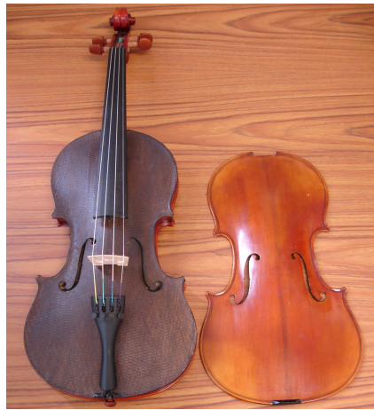
FIGURE III.5 – Violon dont la table d'harmonie d'origine en épicéa (à droite sur la photo) a été remplacée par une structure sandwich balsa/fibre de lin. Figure extraite de [42].
